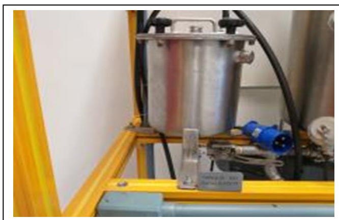
Figura 4 - Tanque catalizador com capacidade de 5 litros
