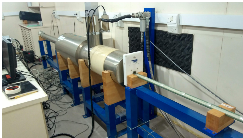
Figura 4.6: Sistema 2G-Enterprises com desmagnetizados AF e magnetômetro criogenico (acervo próprio).
