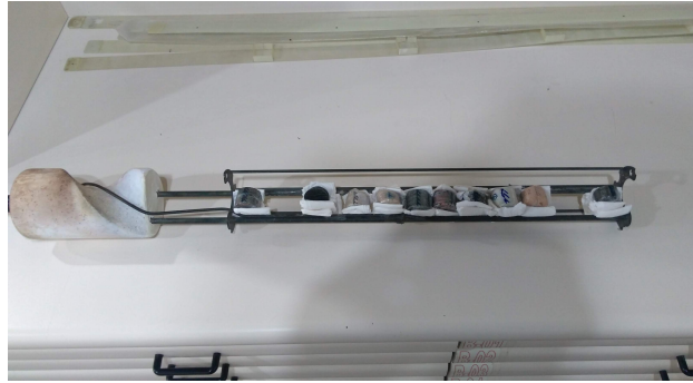
Figura 4.9: Barca diamagnética onde foram alocadas as amostras para o experimento. O conjunto barca e amostras foi inserido no interior do solenoide para dar início ao processo de indução de MRV (acervo próprio).
