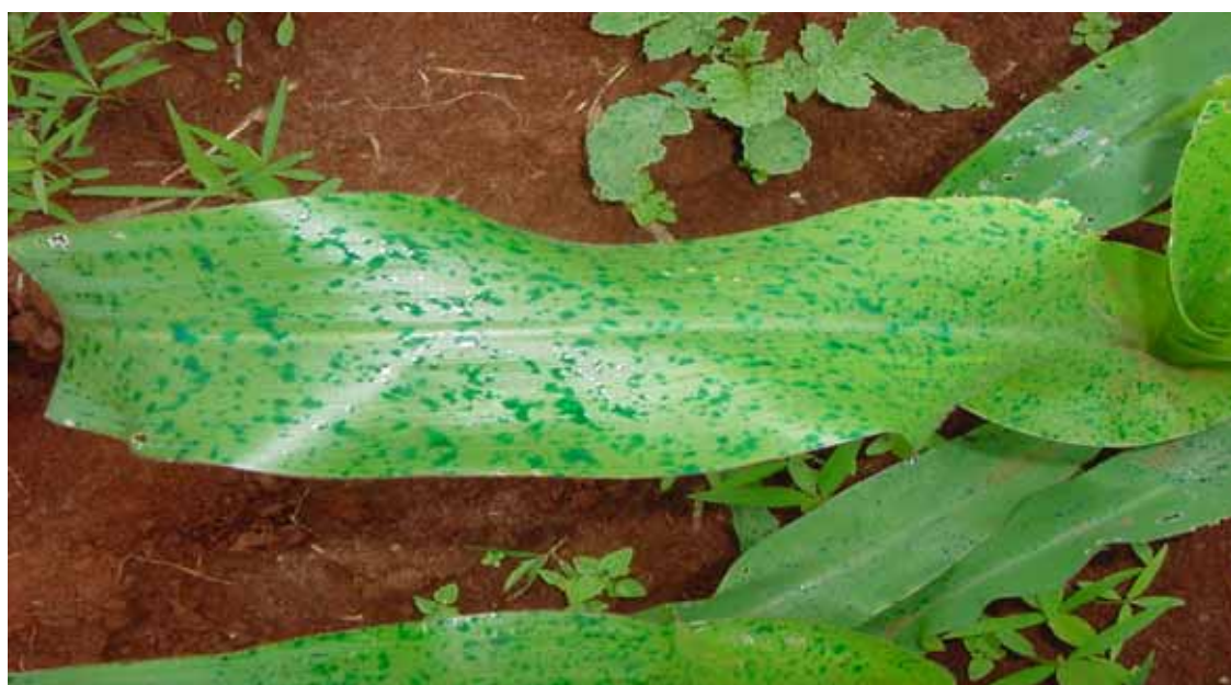
Apêndice 3. Deposição de calda sobre uma planta de milho, proporcionado pela ponta DG 11002 VS a 100 \text{ l.ha}^{-1} , no primeiro estágio de aplicação.
