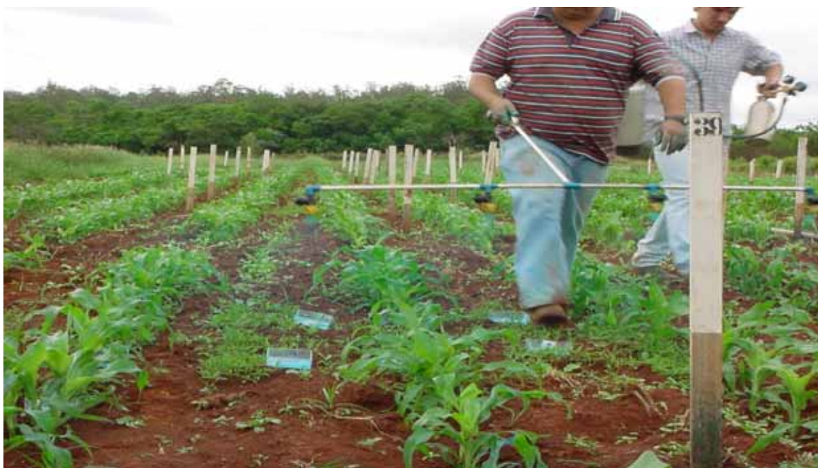
Apêndice 2. Pulverização com ponta DG 11002VS a 100 \text{ l.ha}^{-1} , no primeiro estágio de aplicação. Botucatu/SP, 2003
