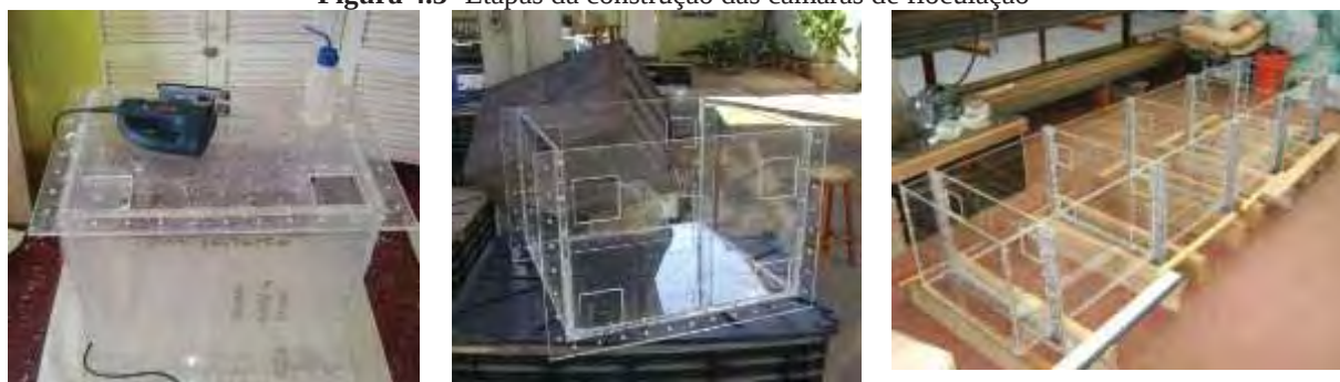
Figura 4.3- Etapas da construção das câmaras de floculação
