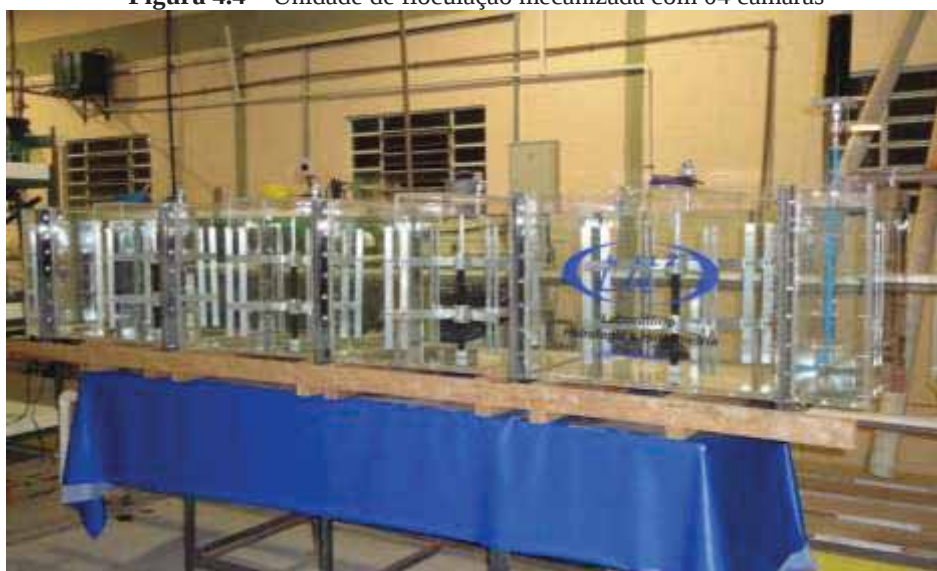
Figura 4.4 – Unidade de floculação mecanizada com 04 câmaras
