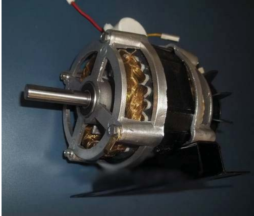
Figura 21: Motor elétrico monofásico da marca GME, utilizado em tanquinhos (Fonte: Mercado Livre)
