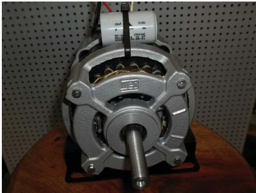
Figura 22: Motor elétrico monofásico da marca WEG, também utilizado em tanquinhos. (Fonte: Mercado Livre)
