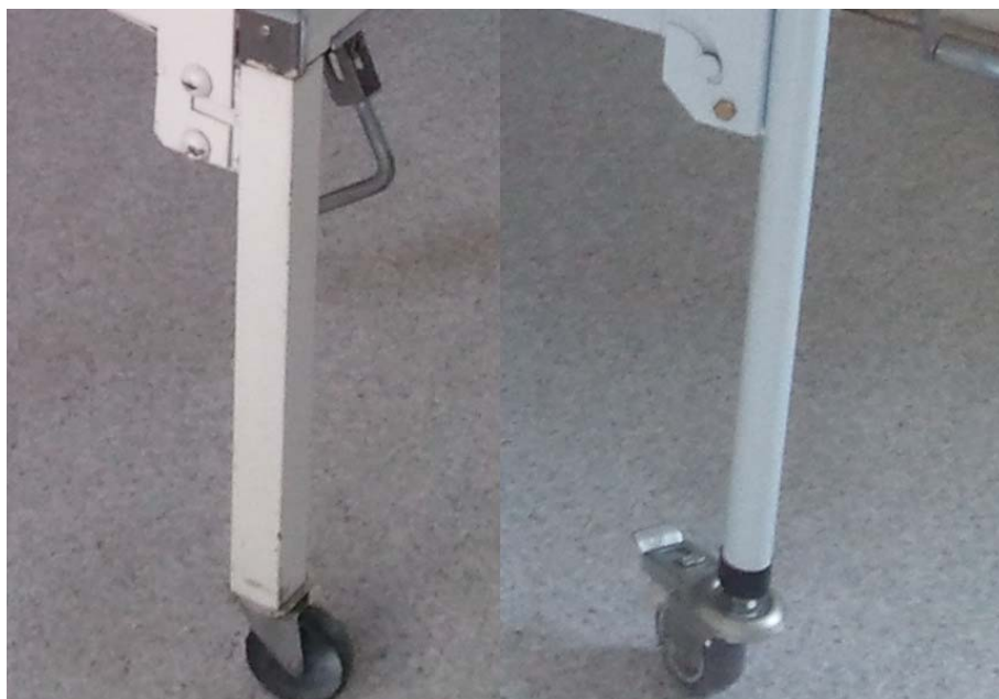
Figura 6: Pés do modelo antigo (esq.) e novo (dir.) (Fonte: Próprio autor)
