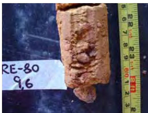
Foto 17 - Silte arenoso com fragmentos de laterita, recuperado do Poço 80 à profundidade de 9,6m.
