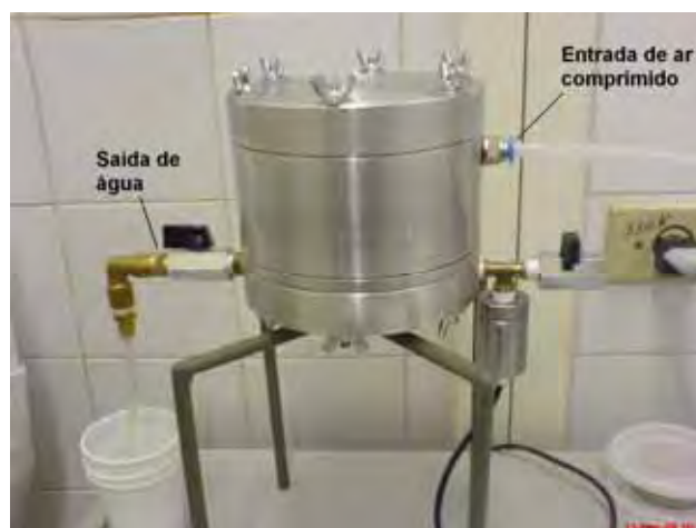
Foto 05 - Câmara de pressão de RICHARDS para determinação da curva de pressão capilar desenvolvida no LEBAC - UNESP.
