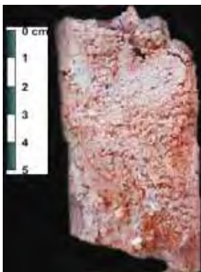
Foto 16 - Argila arenosa. Amostra recuperada do poço PM 66, à profundidade de 12,0 m.
