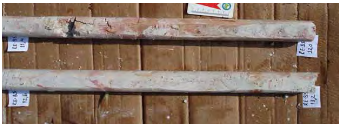
Foto 18 - Argilito cinza, recuperado do poço 85 entre 11,40 a 13,20m de profundidade.
