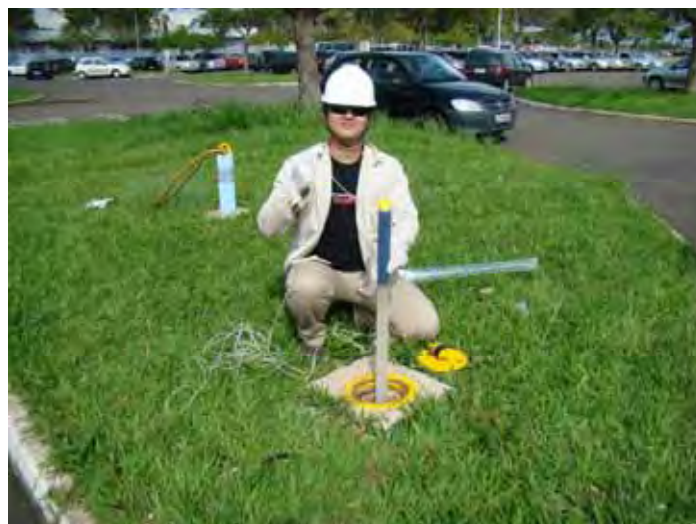
Foto 06 – Coleta de amostra de óleo e água do poço PM-75.
