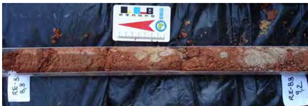
Foto 12 - Solo vermelho areno-siltoso recuperado do poço 88 com profundidade variando de 8,8 a 9,2 m.
