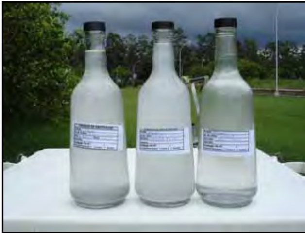
Foto 9 - Emulsão após caixa separadora
