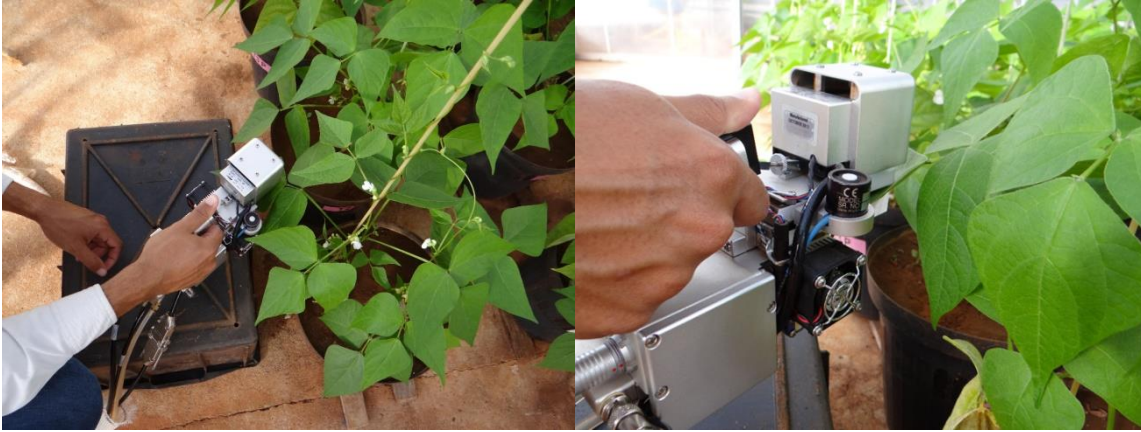
Figura 3 - Leituras de trocas gasosas com IRGA.
