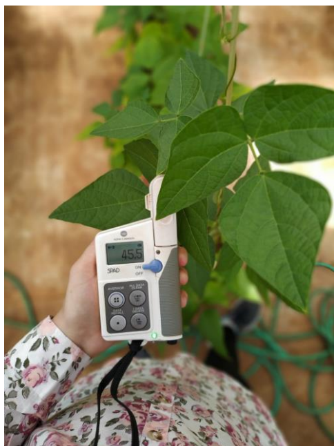
Figura 1 - Leitura do índice relativo de clorofila na folha com o clorofilômetro portátil SPAD-502 Plus.
