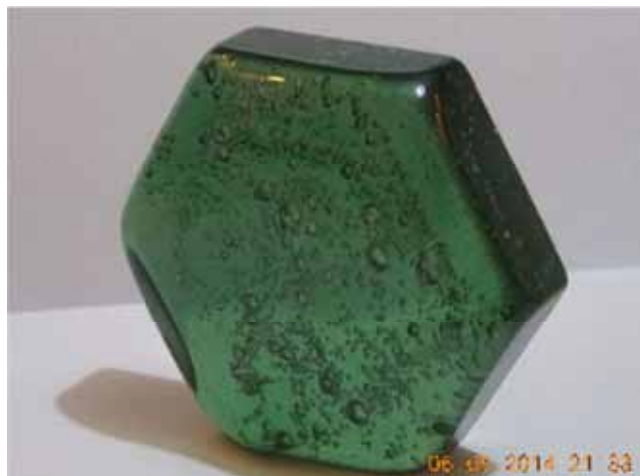
Figura 60 - Fusão da composição I a 1450 °C e recozimento a 800 °C.
