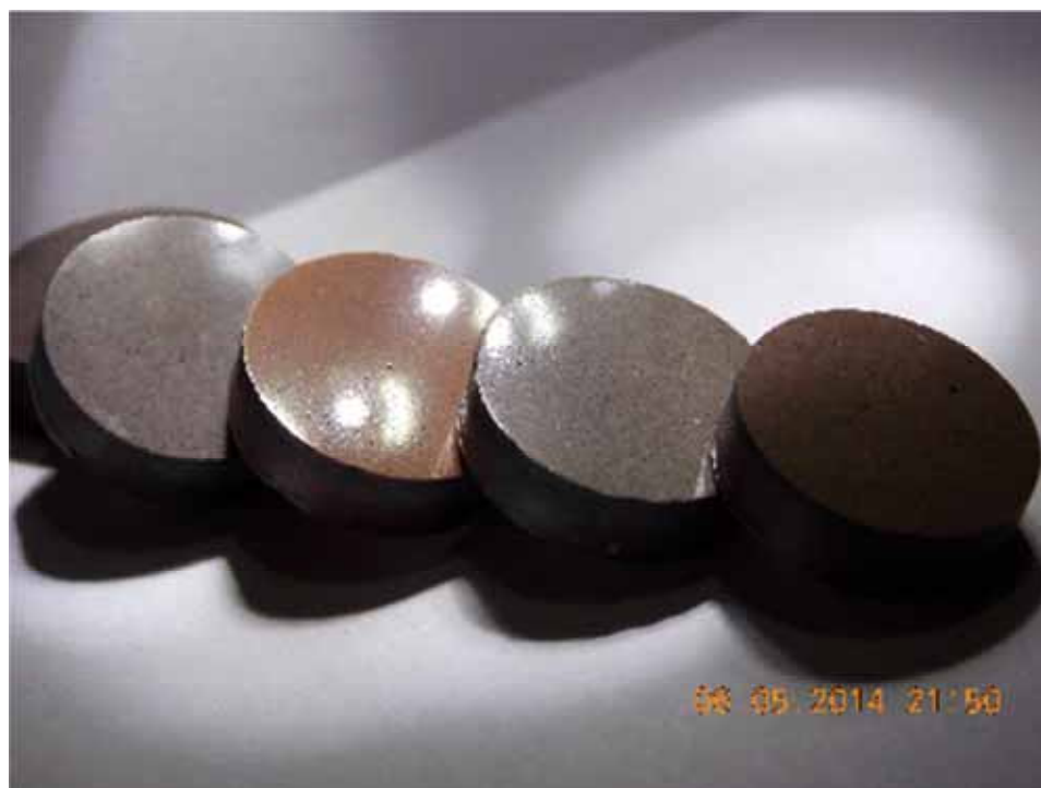
Figura 58 - Amostras da composição I com adição de pigmentos do pó xadrez, com polimento.
