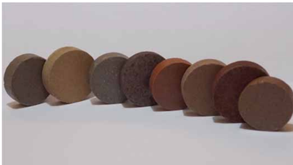
Figura 57 - Amostras da composição I com adição de pigmentos do pó xadrez, sem polimento.
