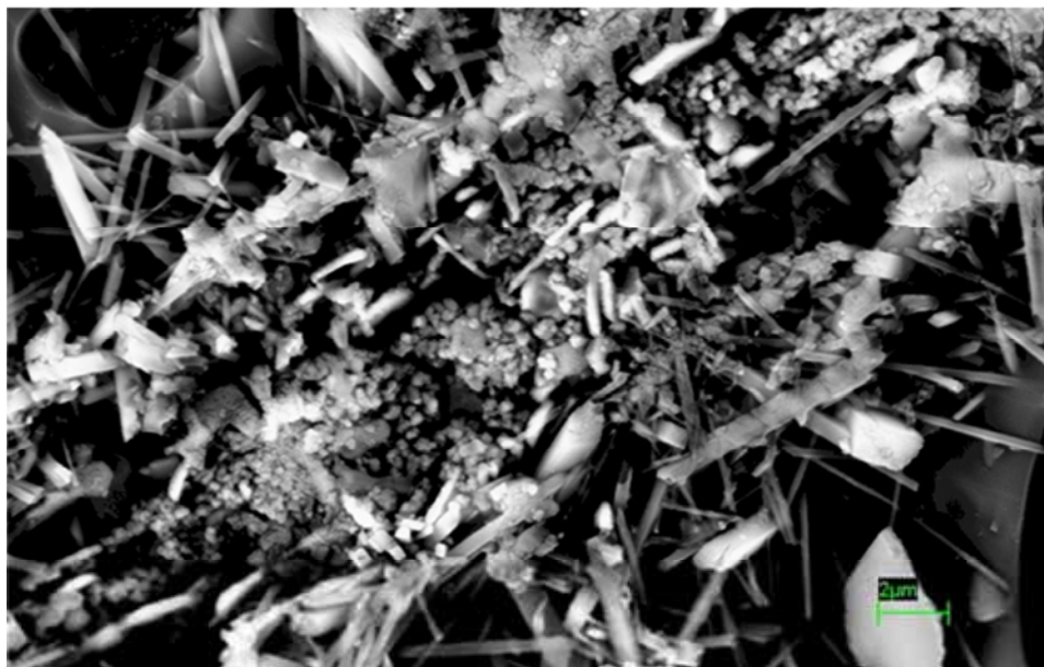
Figura 53 Micrografia obtida por MEV composição II – 9.000X
