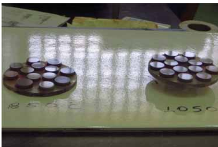
Figura 20 – Corpos de prova colado no prato de vidro com cera de abelha.
