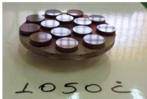
Figura 24 - Amostras polidas obtida a partir da: a) composição I b) composição II.
