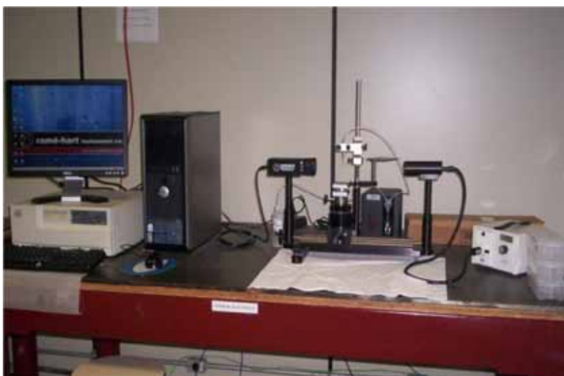
Figura 19 – Fotografia do sistema utilizado para medida do ângulo de contato.
