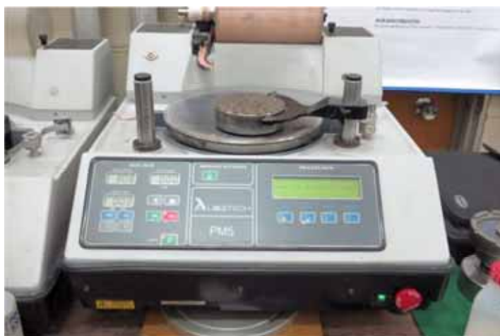
Figura 23 - Politriz Logitech PM-5 – Utilizou-se pasta de diamante de granulação 1 \mu\text{m} marca Arotec.
