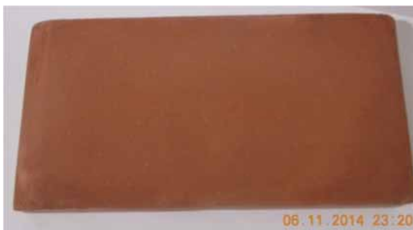
Figura 59 – Rocha sintética, obtida a partir da composição I, com dimensões de 20x10x2,7cm.
