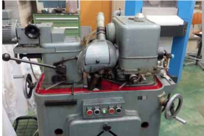
Figura - 21: Geradora de superfície LOH. Utiliza rebolo diamantado para processamento.
