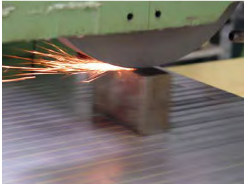
Figura 12 - Operação de retificação sem fluido de corte para o desgaste do rebolo
