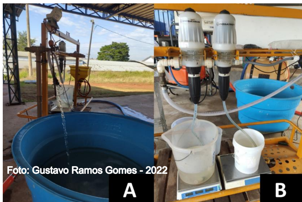
Figura 10 - Tanque caixa d'água sendo abastecida pelo fluxo de água que passava pelos dosadores a fim de atingir 100 litros da soma do que os dosadores succionavam para dentro do fluxo (a) e os baldes posicionados em cima de uma balança de precisão para a obtenção dos valores de diferença de massas (b)
