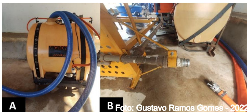
Figura 8 - Tanque de 300 litros para o abastecimento do sistema de fluxo (a) e o engate do protótipo para conectar a mangueira de abastecimento do tanque (b)
