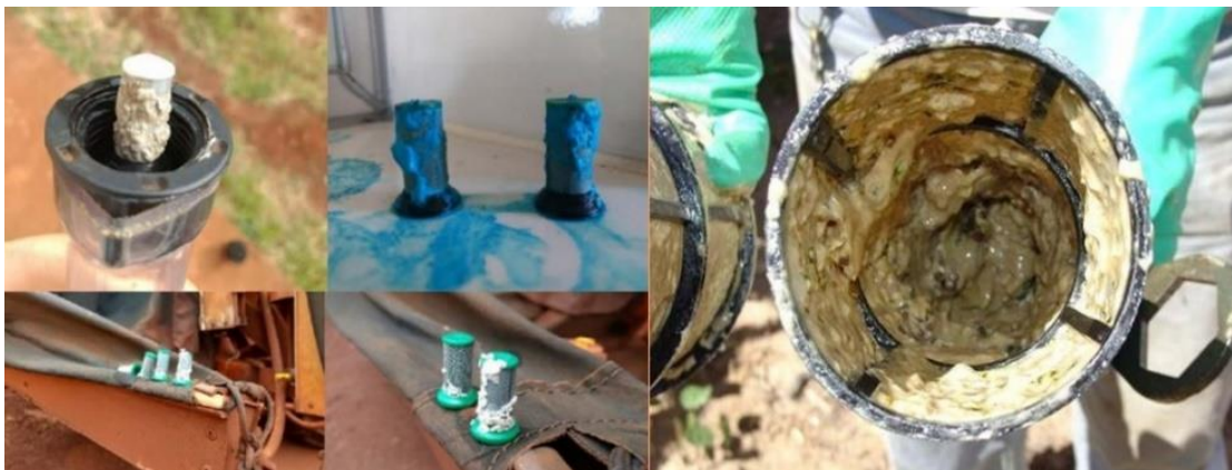
Figura 1 - Filtros do sistema de um pulverizador entupidos
