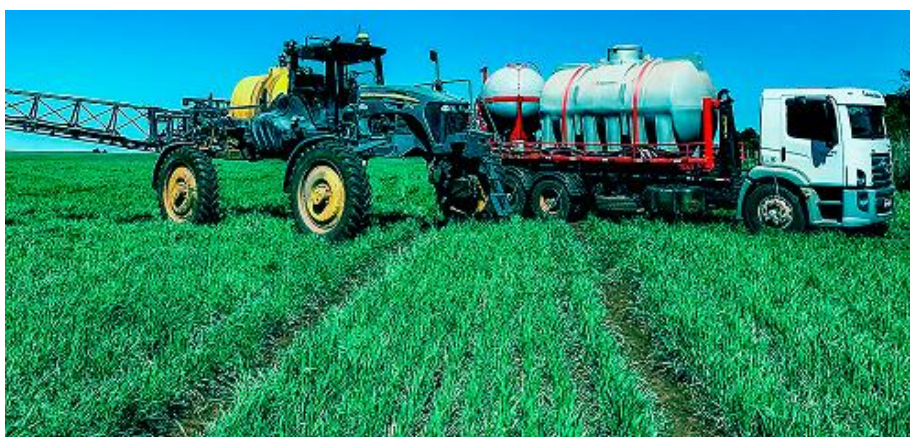
Figura 4. Sistema de calda pronta no abastecimento de um pulverizador
