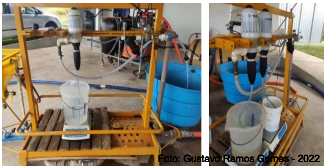
Figura 5 - Sistema de bombeamento por fluxo e seus componentes dosadores
