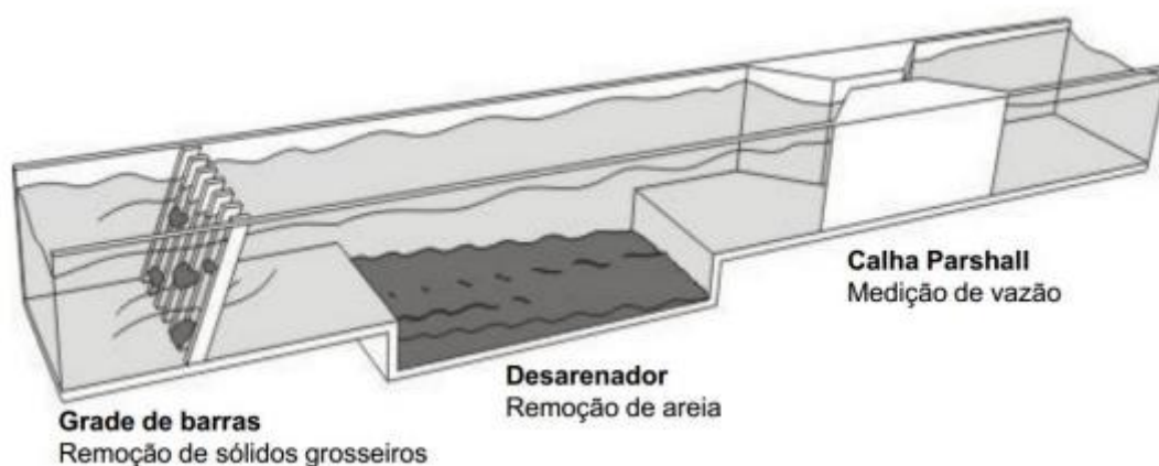
Figura 3: Tratamento preliminar de esgoto
