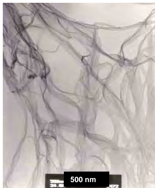
Figura 18 - Micrografia Eletrônica de Transmissão de celulose bacteriana liofilizada.
