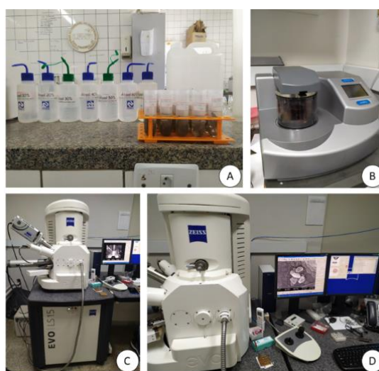
Figura 2: A: Processo de desidratação das amostras; B: Amostras sendo revestidas por ouro (Quorum Q150T E); C: Microscópio Eletrônico de Varredura (Zeiss EVO LS15); D: Obtenção das imagens dos tricomas glandulares
