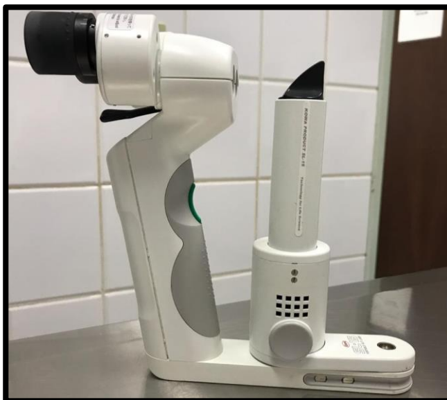
Figura 4. Imagem fotográfica da lâmpada de fenda portátil SL-145, Kowa, utilizada para biomicroscopia. Jaboticabal, 2019.
