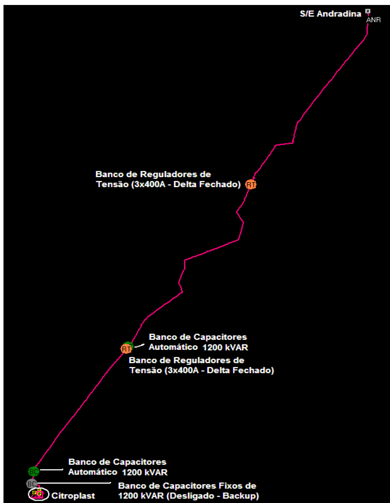
Figura 10 -Diagrama unifilar do alimentador 01
