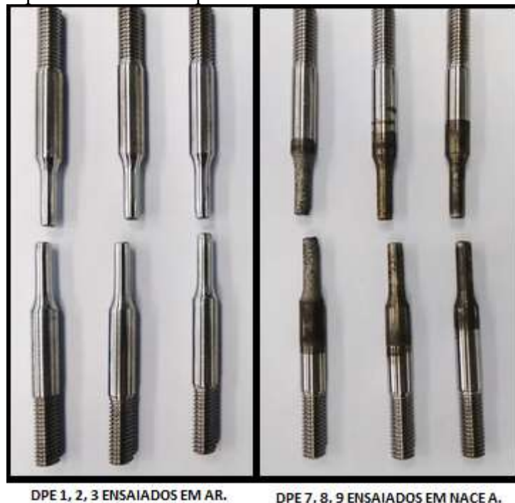
Figura 24 - Corpos de prova entalhados após ensaio.
