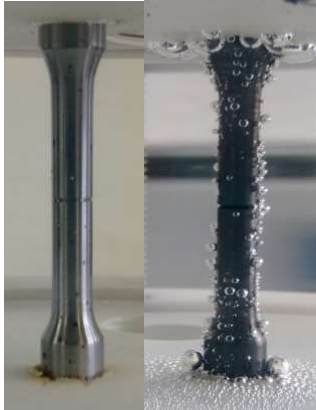
Figura 25 - Pontos de corrosão e bolhas na superfície do corpo de prova ensaiado em solução NACE A.
