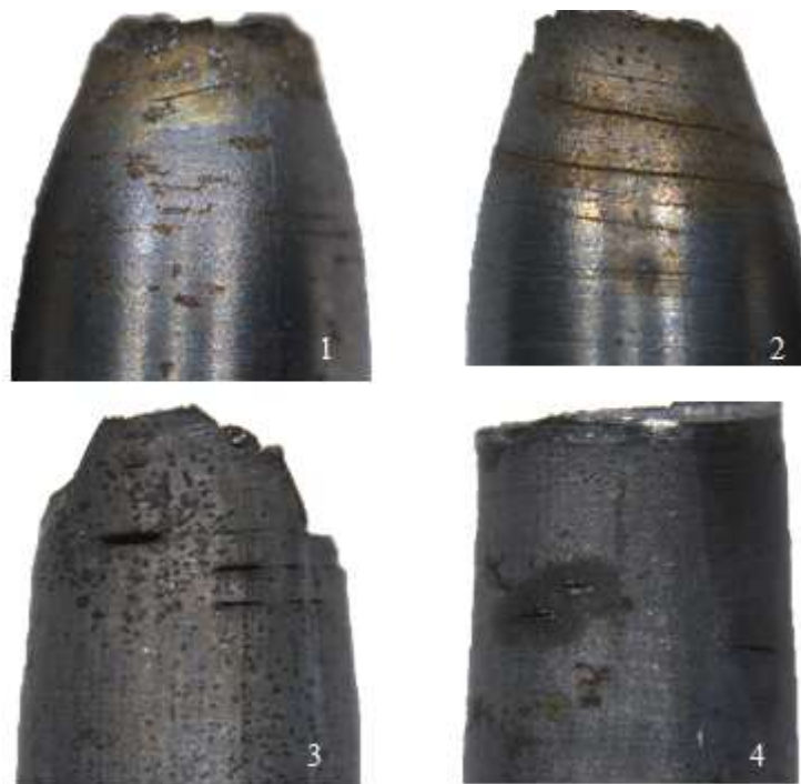
Figura 23 - Múltiplas trincas, 1 e 2 ensaiados em água do mar sintética e 3 e 4 ensaiados em solução NACE A.
