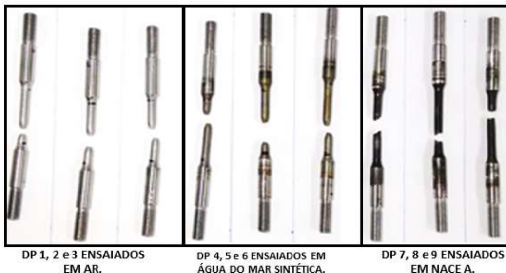
Figura 9 - Corpos de prova após ensaio.
