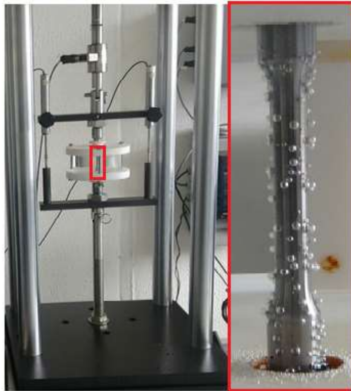
Figura 19 - Formação de bolhas na superfície do corpo de prova durante o ensaio BTB em solução NACE A.
