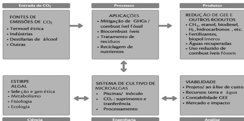
Figura 9: Esquema do processo de biofixação do CO 2 por microalgas
