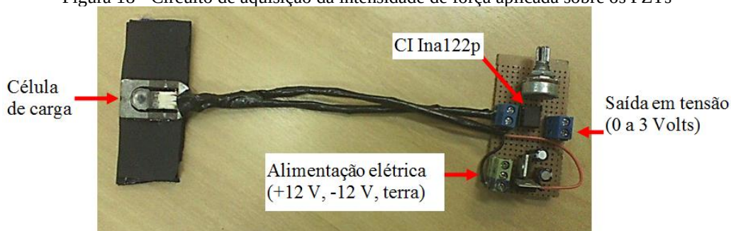
Figura 18 - Circuito de aquisição da intensidade de força aplicada sobre os PZTs
