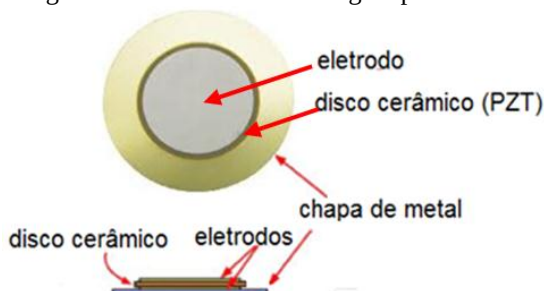
Figura 16 - Estrutura do diafragma piezelétrico
