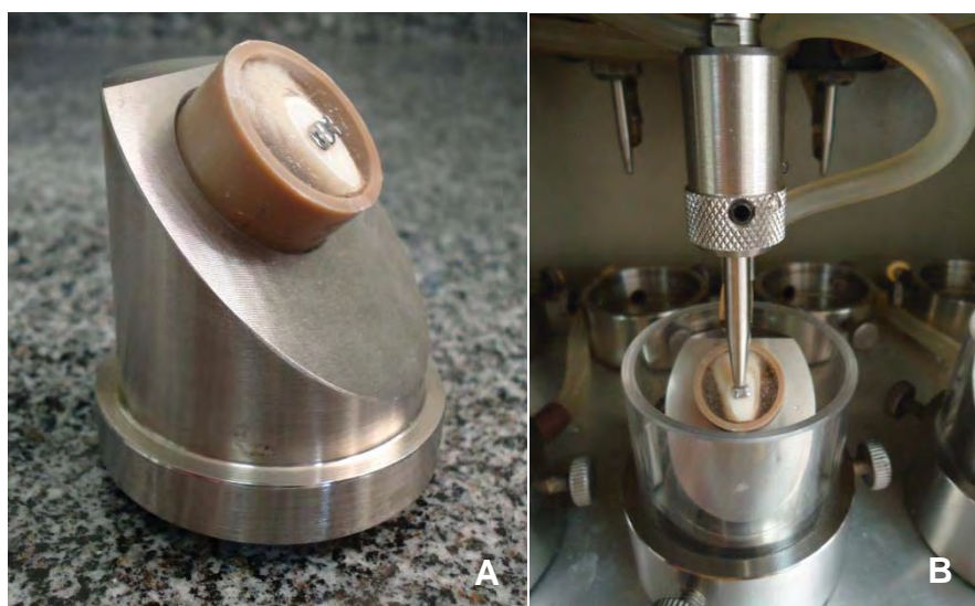
Figura 2 - Corpo-de-prova posicionado para fadiga artificial: a) base de 45°; b) base e CP instalados no interior da máquina de fadiga.
