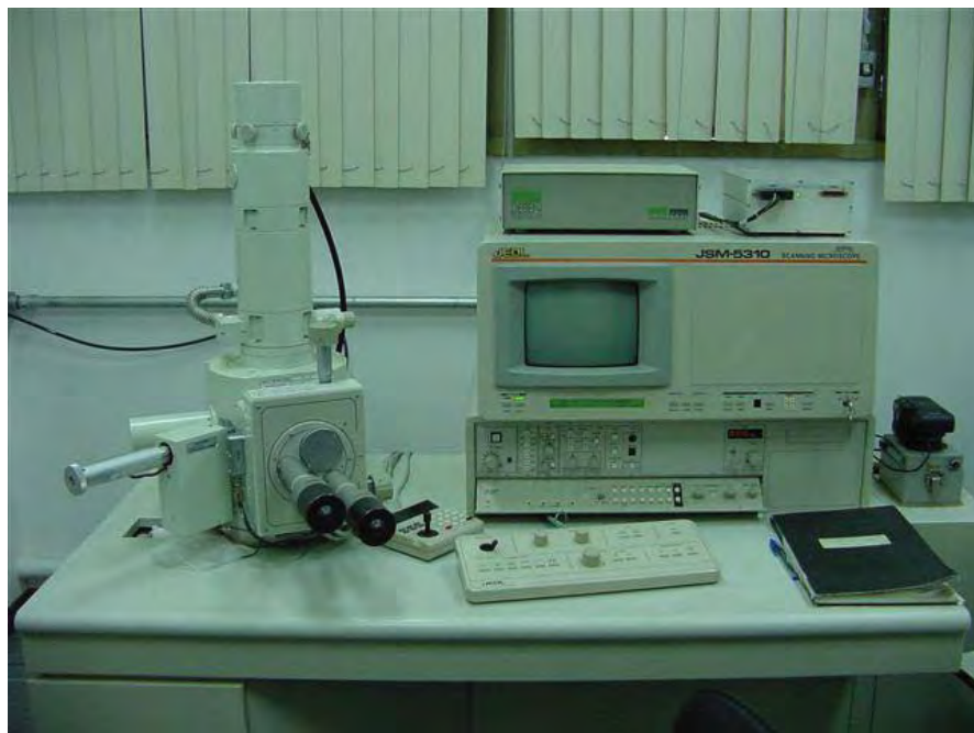
Figura 9 - Microscópio Eletrônico de Varredura (MEV) do INPE (Instituto Nacional de Pesquisas Espaciais) onde foi realizada a análise microscópica.
