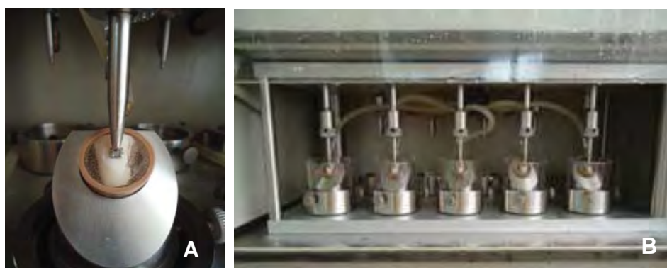
Figura 3 – Corpo-de-prova posicionado para fadiga mecânica: a) pistão incidindo sobre o bráquete; b) CPs instalados no interior da máquina de fadiga.
