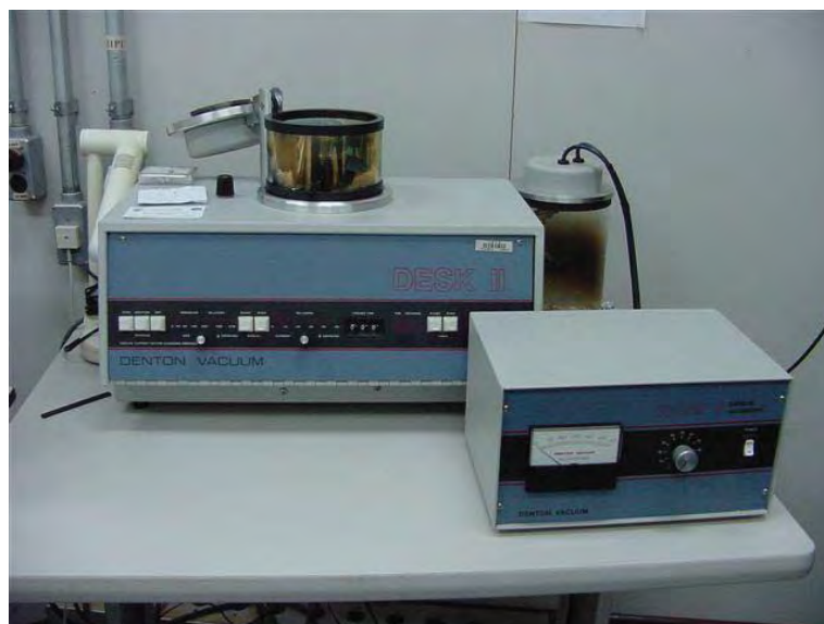
Figura 8 - Evaporador de alta pressão DV – 502-Dentron NJ, onde os CPs foram metalizados com ouro para tornarem-se condutores.
