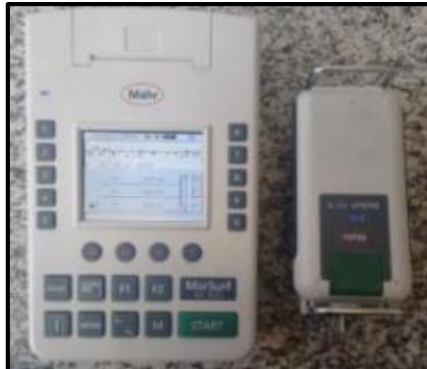
Figura 29: Rugosímetro marca Mahr modelo Marsurf M300
