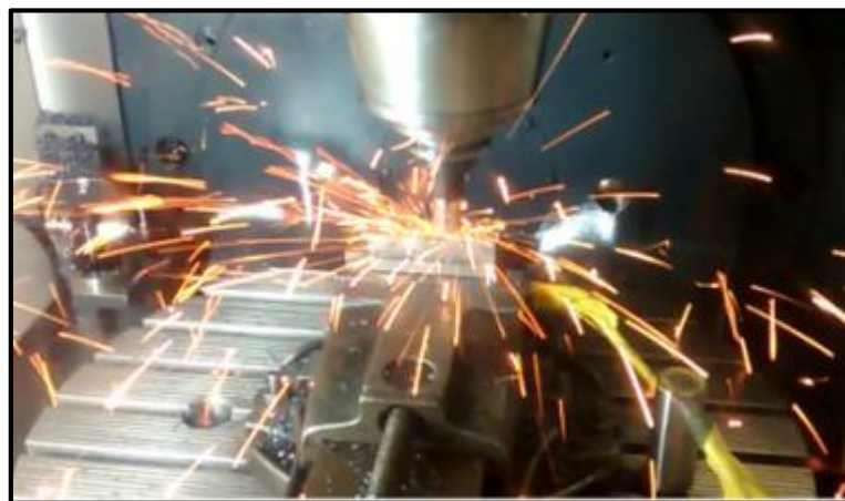
Figura 21: fresamento do aço 4340 endurecido
