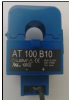
Figura 24: Sensor de efeito Hall marca LEM modelo AT 100 B10.
