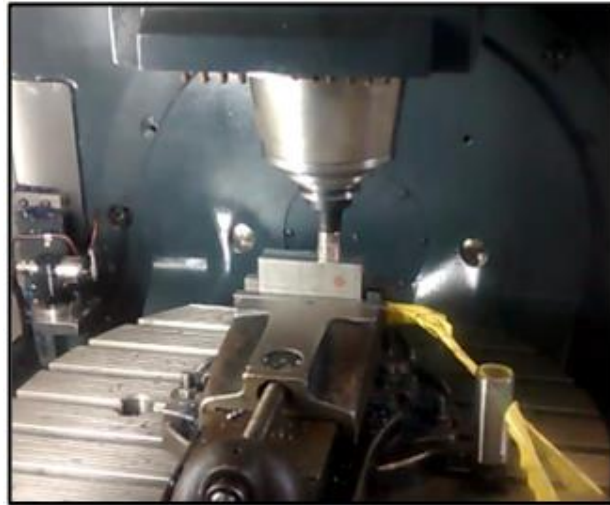
Figura 20: Fresamento do aço 4340 recozido.
