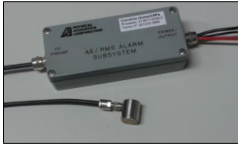
Figura 25: um sistema de captação de emissão acústica da marca PHYSICAL ACOUSTICS CORPORATION
