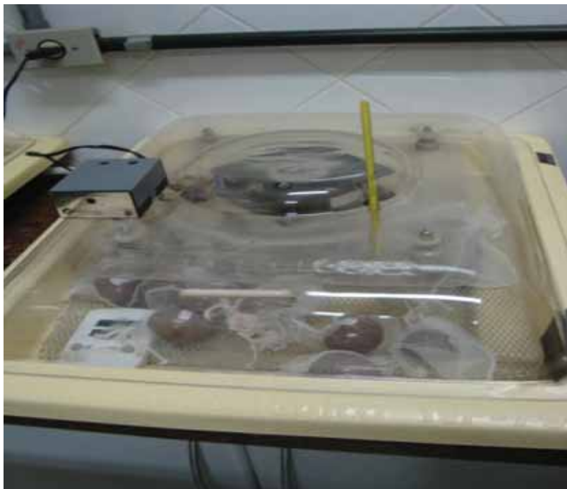
Figura 3. Nascidouro em que os ovos são colocados individualmente no saco de filó (após 16 dias de incubação).
