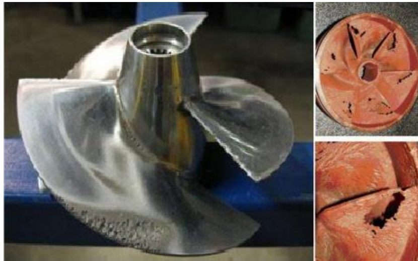
Figura 3 – Exemplo de rotores de turbinas hidráulicas danificados por cavitação.
