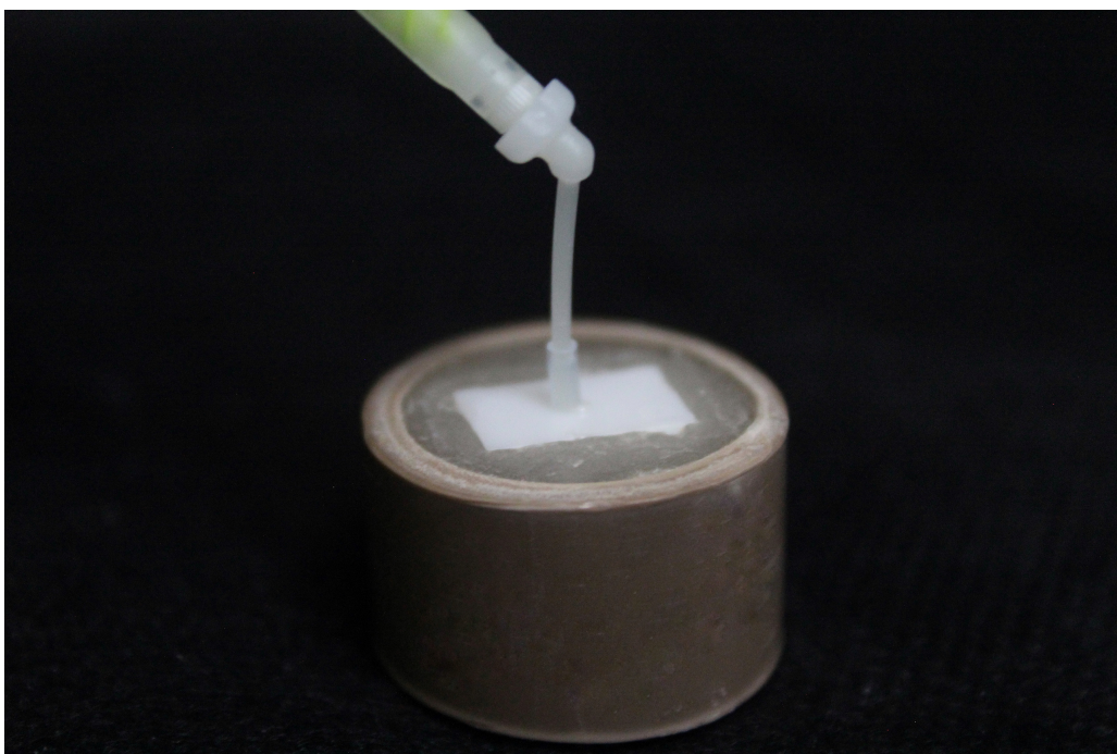
Figura 5 - Mistura de pastas base e catalisadora com ponta misturadora e aplicação na matriz de silicone para construção do cilindro de cimento resinoso
