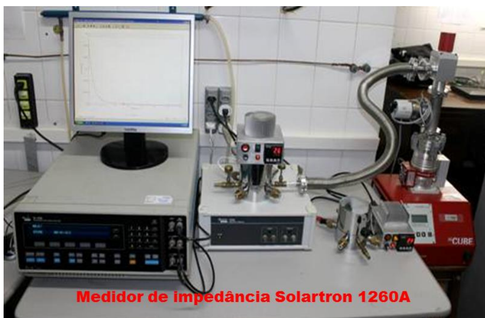
Figura 3.16: Fotografia do analisador de impedância 1260 ( Solartron ) com o criostato e o monitor do micro computador de controle. Fonte: próprio autor
