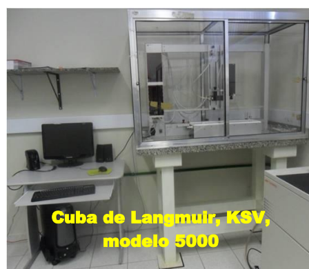
Figura 3.12: a) Desenho esquemático da cuba de Langmuir. Fonte: Ref. [120] e b) Cuba de Langmuir, KSV, modelo 5000. Fonte: Próprio autor.
