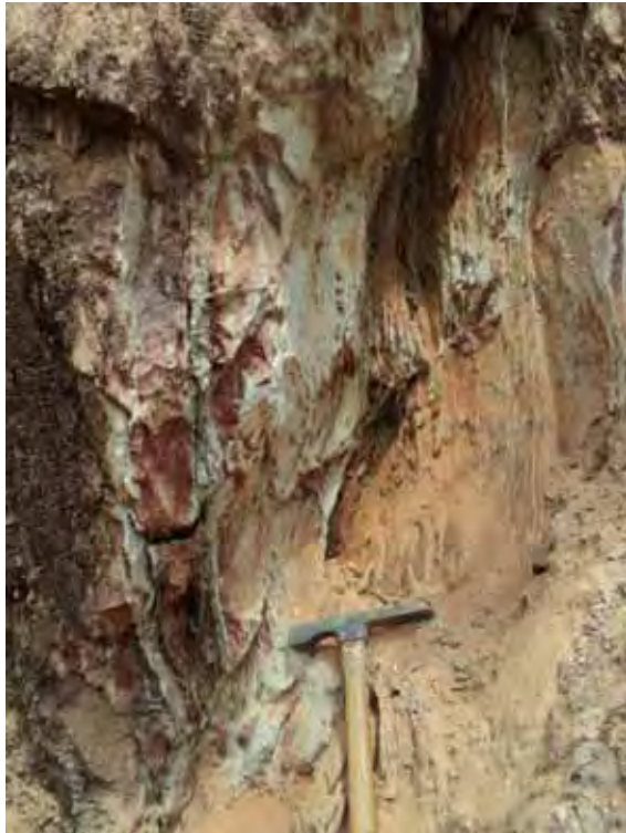
Figura 25 – Par de falhas inversas afetando filitos alterados em afloramento na Rodovia Transamazônica (aflor 15), cortando os traços da foliação / bandamento composicional. Na esquerda, planos de falas inclinados para SE e SSE (lado esquerdo da foto). À direita, vista (de baixo para cima) do plano estriado de uma das falhas da foto ao lado, com estrias marcadas sobre o material ferruginoso da crosta laterítica.
