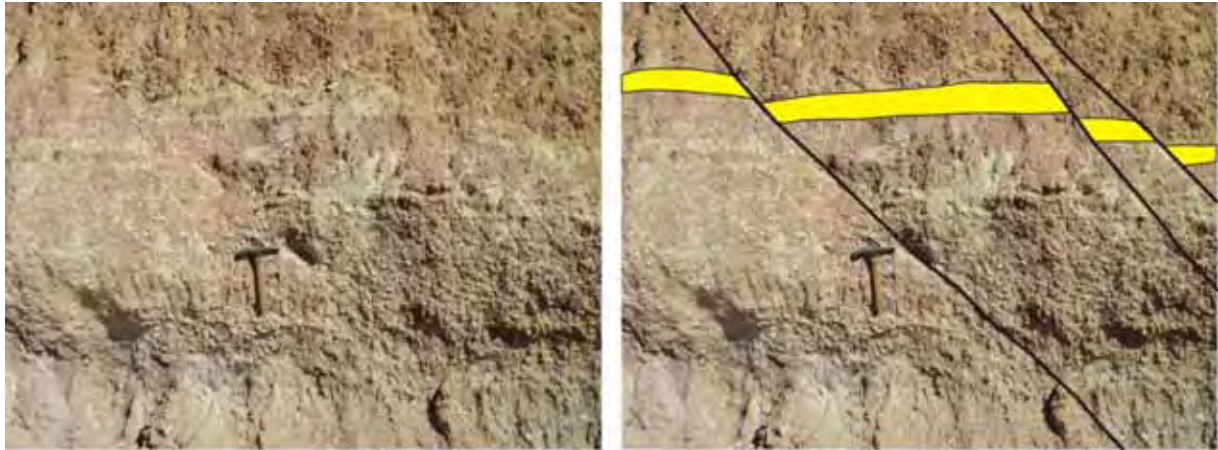
Figura 11: Conjunto de falhas normais de rejeito decimétrico, com blocos progressivamente abatidos para a direita da foto (abatidos no sentido NE), no sentido da Rodovia Transamazônica, em direção à margem esquerda do Rio Tocantins (Rod. Transamazônica).
