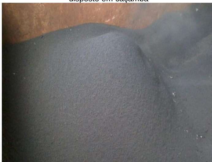
Figura 7 - Lodo da ETE Araraquara após processo de desaguamento e secagem térmica a 300 °C disposto em caçamba
