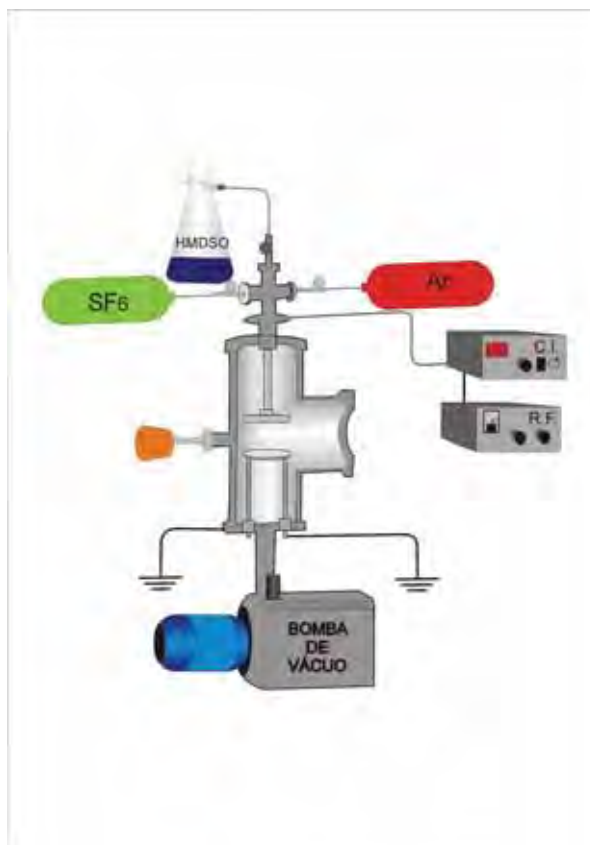
Figura 5- Esquematização dos aparatos utilizados no processo de PECVD.
