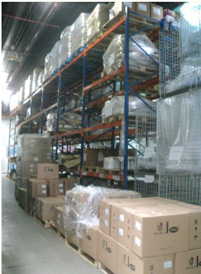
Figura 7 - Materiais armazenados nos corredores entre as estantes porta-paletes. Fonte: Foto tirada na fábrica pelo autor.
