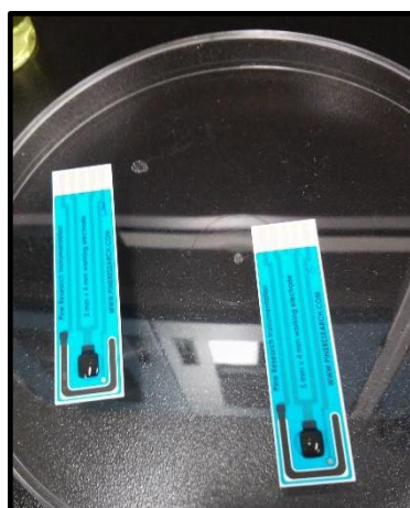
Figura 23 - Eletrodo SPCE utilizado nas análises por EIE
