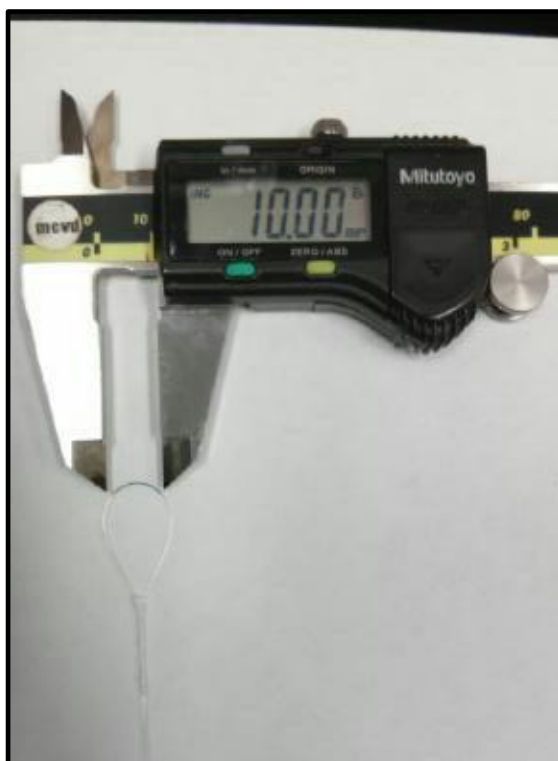
Figura 35 - Foto do imunossensor após todas as etapas de funcionalização, com destaque para a área funcionalizada
