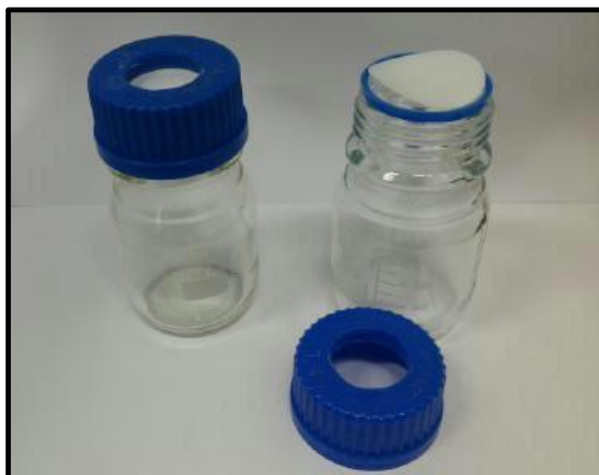
Figura 14 - Sistema utilizado na GDME aplicado na determinação de formaldeído
