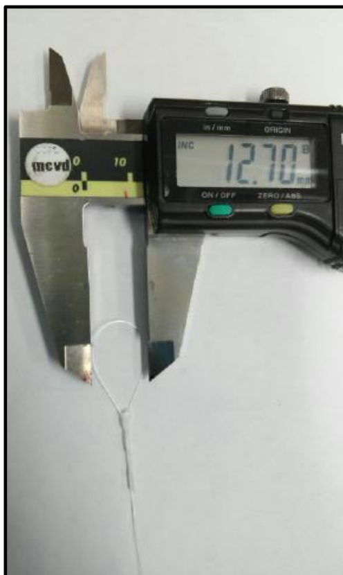
Figura 33 - Imagem da fibra dobrada em “U” evidenciando o raio de curvatura
