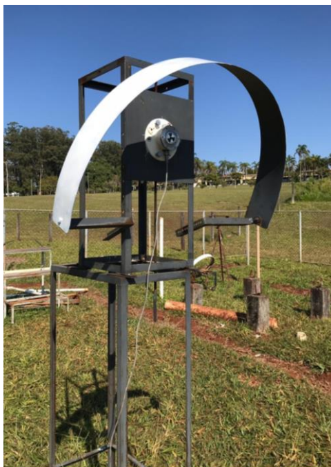
Figura 4 - Piranômetro Eppley 8-48 em superfície vertical ao Norte sob anel de sombreamento MEO
