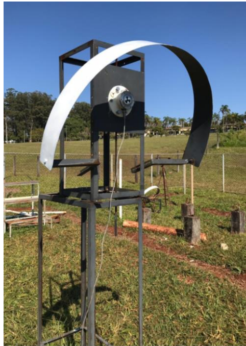
Figura 3 - Piranômetro Eppley 8-48 em superfície vertical ao Norte sob anel de sombreamento MEO
