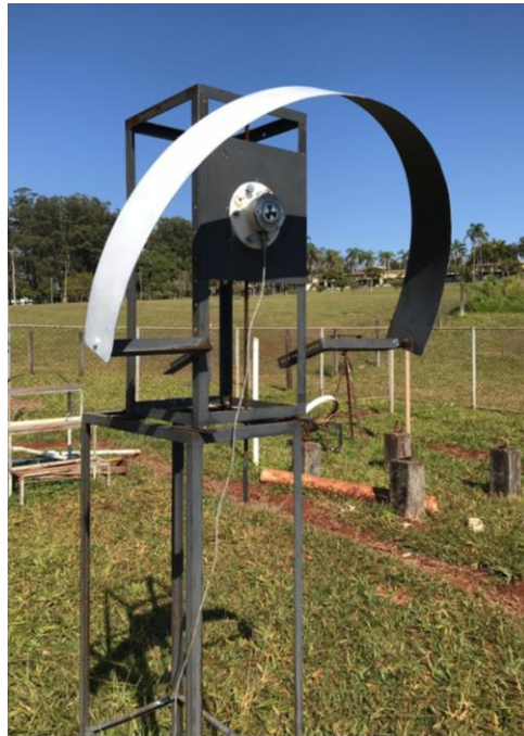
Figura 2 - Piranômetro Eppley 8-48 em superfície vertical ao Norte sob anel de sombreamento MEO.
