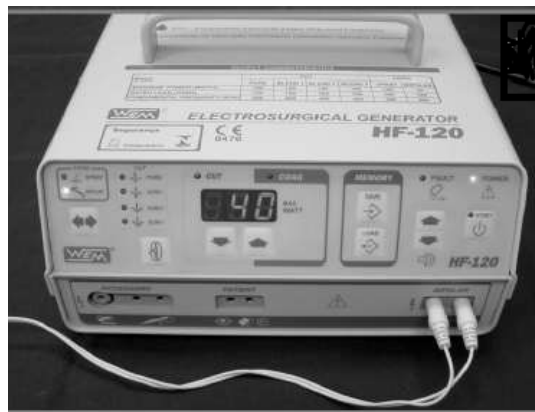
Figura 3. Gerador de eletrocirurgia configurado para coagulação bipolar, com potência de 40 watts, utilizado para eletrocauterização bipolar dos pedículos ovarianos. Fonte: Silva, 2012.
