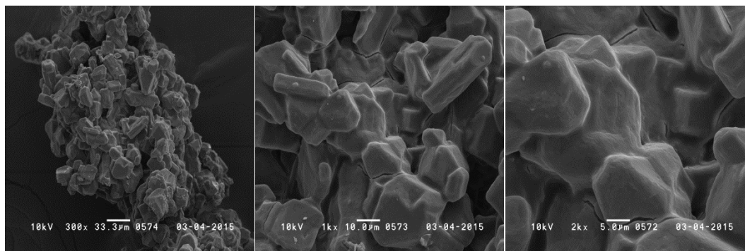
Figura 28: Micrografia obtida por MEV das \gamma -KCD antes da ativação.
