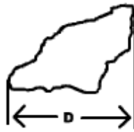
Figura 12: Figura representativa do diâmetro de Feret (D) na direção horizontal
