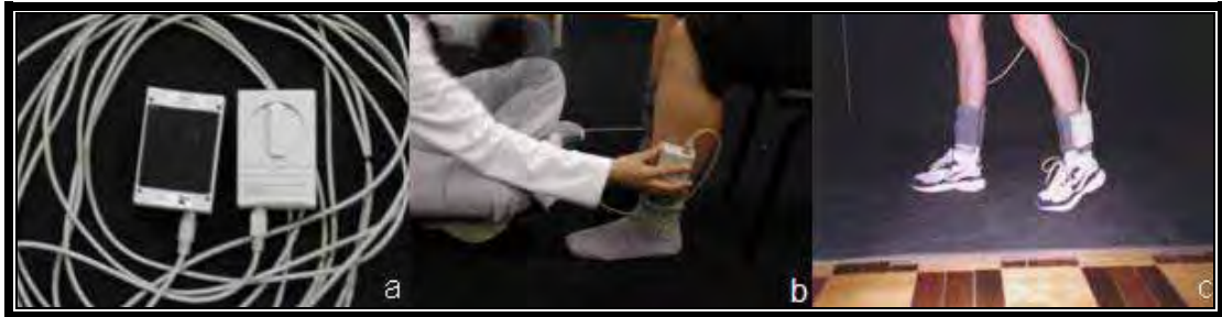
Figura 21 - (a) Cuff (unidade do tornozelo), (b) colocação do cuff no sujeito e (c) sujeito com F-Scan® (MANN et al., 2008).
