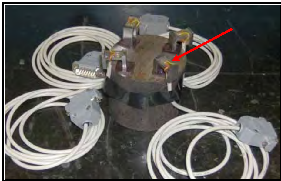
Figura 30 – Soldagem dos fios nas células de carga (indicado pela seta vermelha) e os respectivos conectores.
