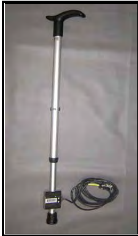
Figura 44 – Bengala de alumínio com altura regulável adaptada a célula de carga de 50 kg da HBM.
