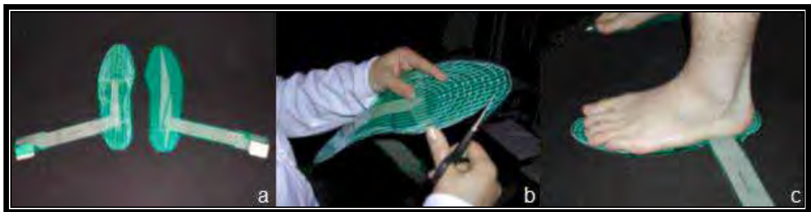
Figura 20 - (a) Palminha do sistema F-Scan ® , (b) palminha do sistema F-Scan ® sendo cortada e (c) colocação da palminha no sujeito (MANN et al., 2008).
