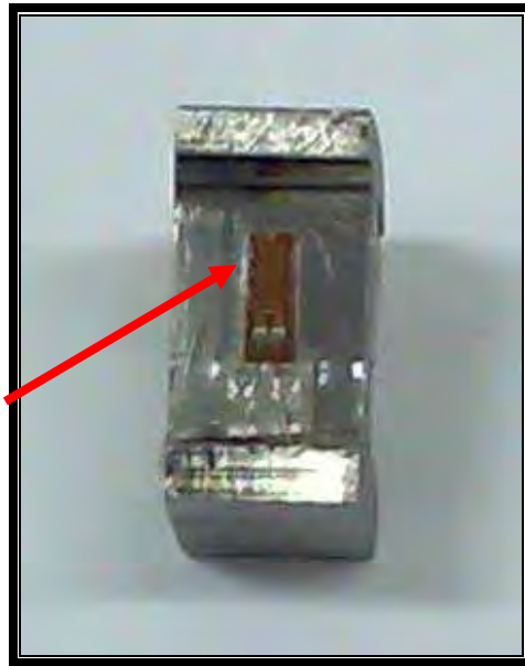
Figura 29 – Extensômetro (indicado pela seta vermelha) colado na célula de carga.
