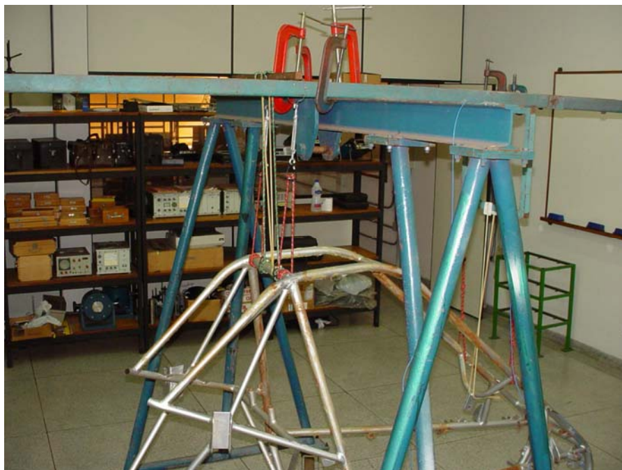
Figura 6.33 – Estrutura suspensa, condição livre-livre.
