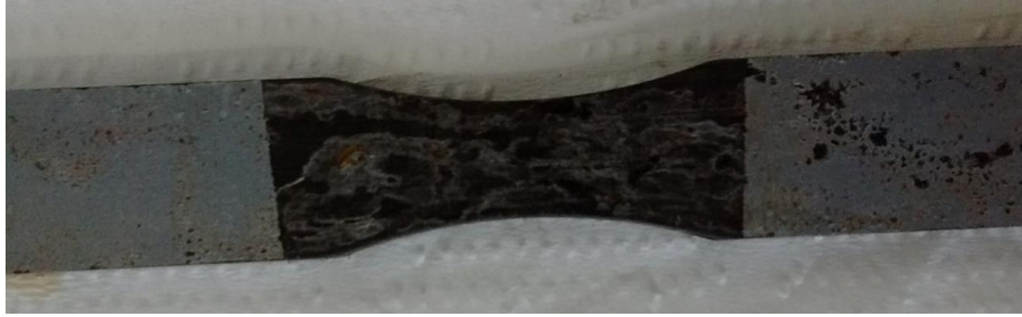
Figura 34 – Corpo de prova após remoção da corrosão
