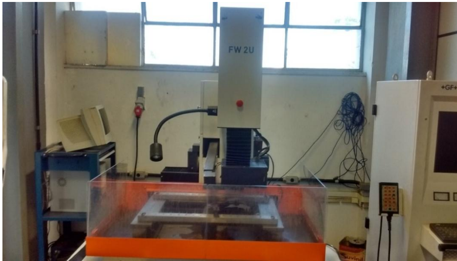
Figura 24 - Eletroerosão - GF Machining Solutions, modelo FW 2U
