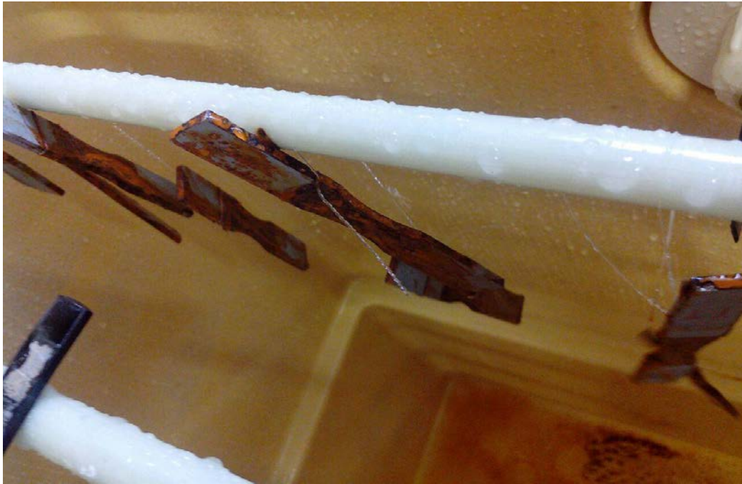
Figura 32 - Corpos de prova durante etapa de corrosão
