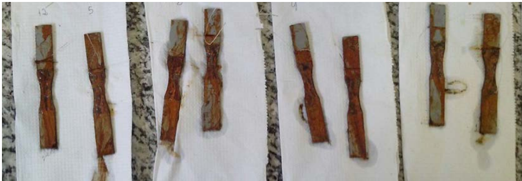
Figura 33 - Corpos de prova após etapa de corrosão
