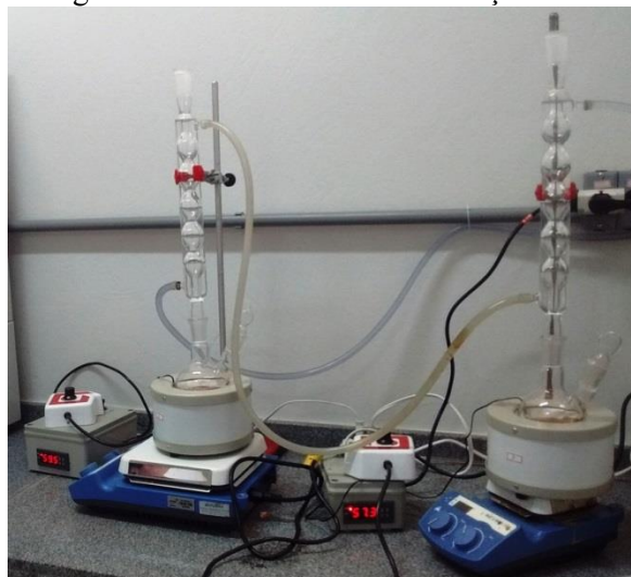
Figura 3. 1. Montagem do sistema utilizado nas reações de transesterificação.
