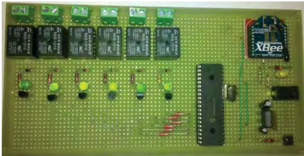
Figura 23 – Placa finalizada do circuito do receptor
