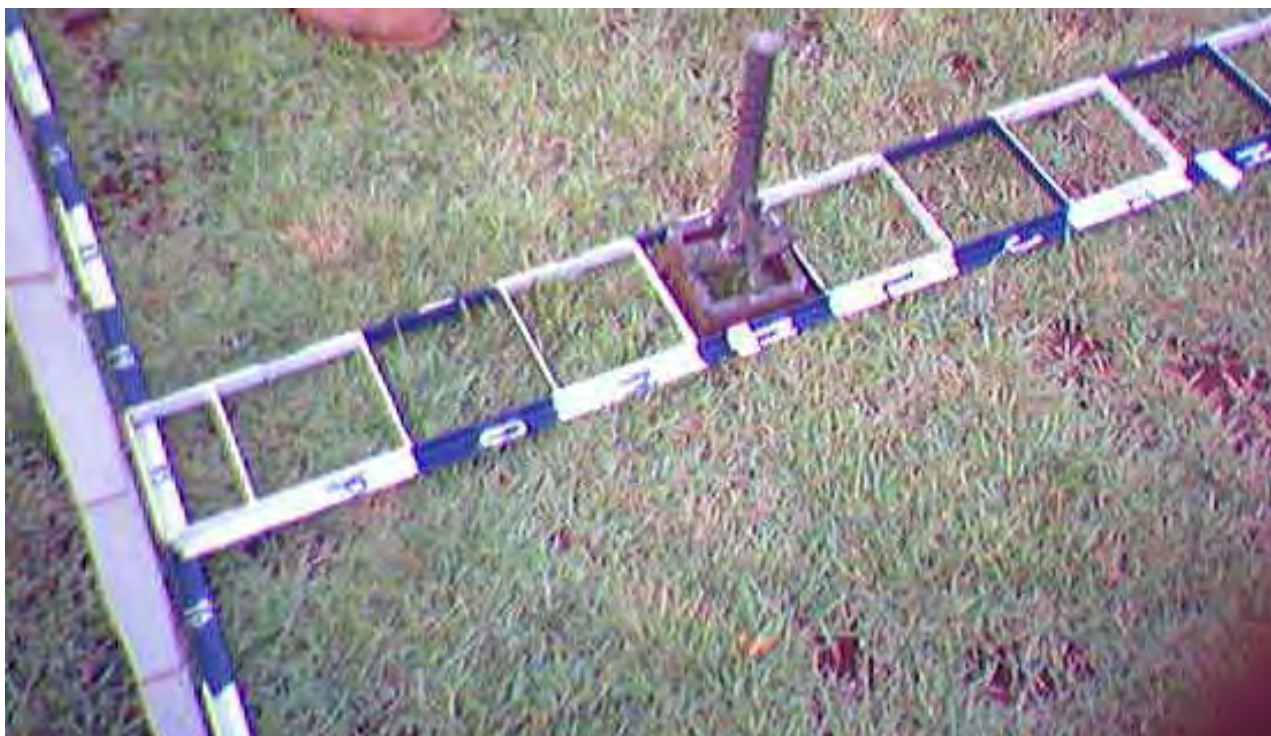
Figura 3 – Detalhe do gabarito e extrator.
