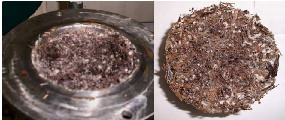
Figura 4.13. Aspecto do fungo ao fim do processo fermentativo em biorreator de leito fixo.
