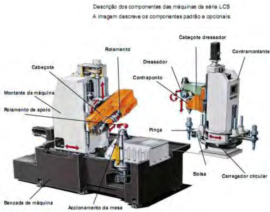
Figura 5.1: Componentes da Máquina Fonte: Gear Cutting Technology (2004)
