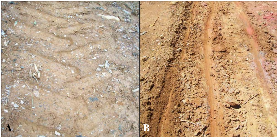
Figura 8 – (A) Foto do recalque da 1ª passada do pneu do trator Skidder; (B) Recalques dos fustes da 1ª passada.
