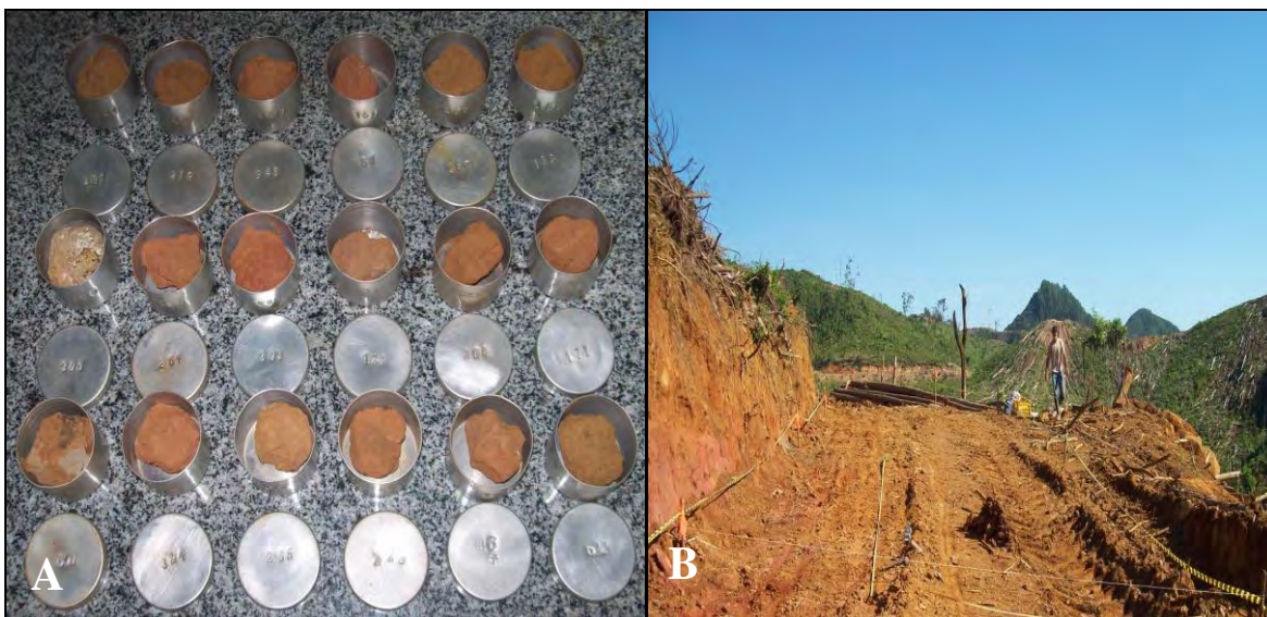
Figura 10 – (A) Amostras de solo para determinação do teor de água; (B) Foto da área do experimento.
