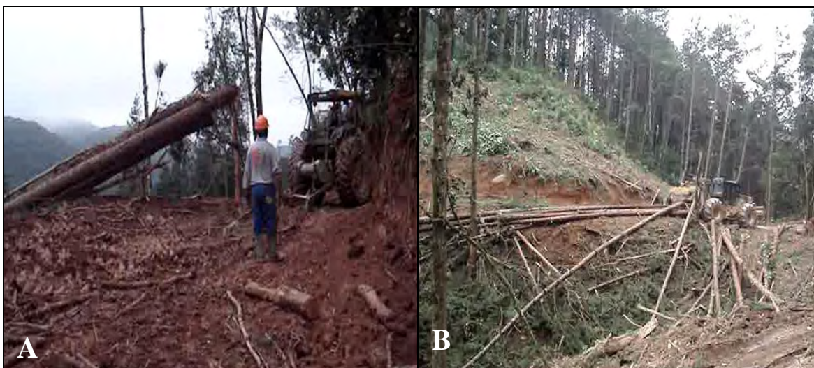
Figura 5 – (A) Representa o trator agrícola com Guincho TMO ® arrastando os fustes e árvores do interior do talhão e ajudante do guincho ao centro da foto; (B) Momento em que o trator Skidder arruma os fustes e árvores na beirada do ramal secundário para arrastá-los até o pátio de processamento.
