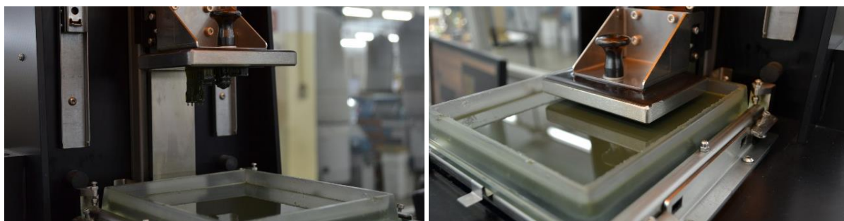
Figura 8 - Mesa de uma máquina descendo sobre a resina líquida
