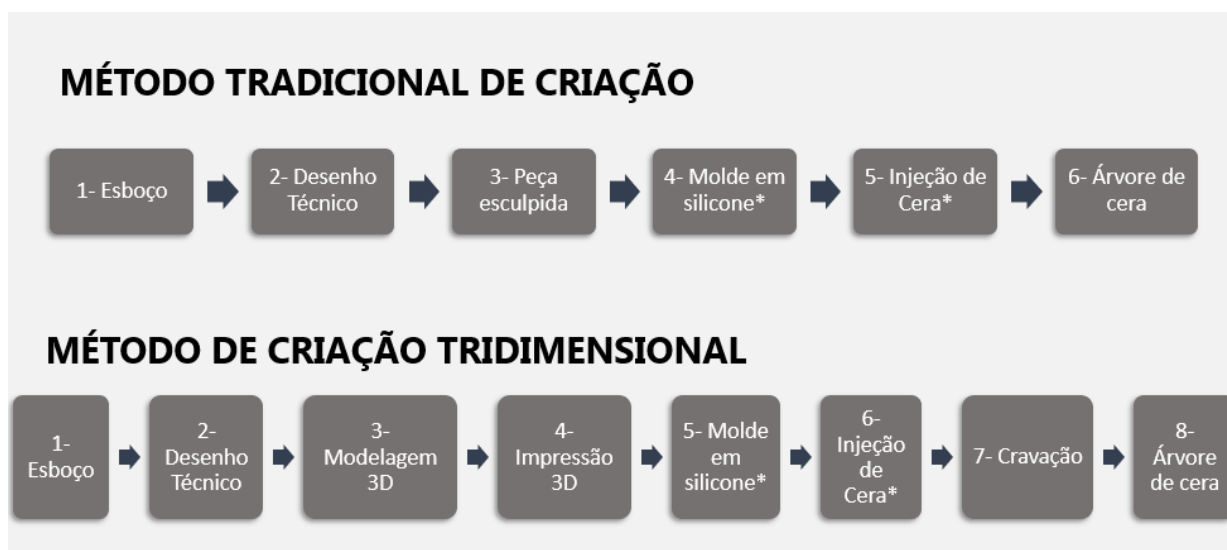
Figura 1 - Etapas de fabricação na indústria joalheria: tradicional x uso de impressão 3D
