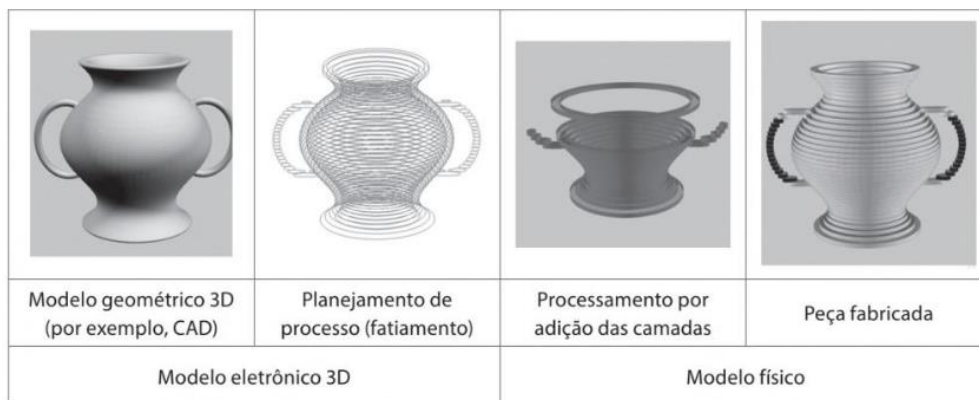
Figura 7 - Representação das principais etapas do processo de manufatura aditiva.
