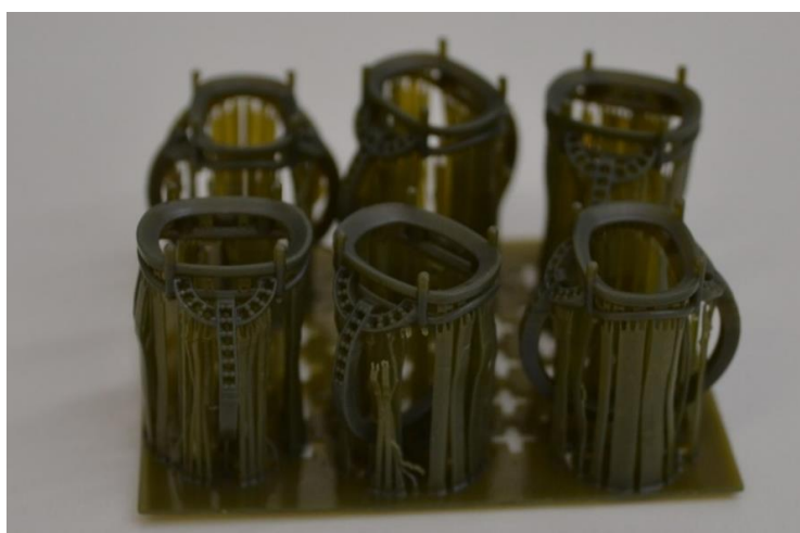
Figura 15 - Protótipos ainda com suportes de sustentação.
