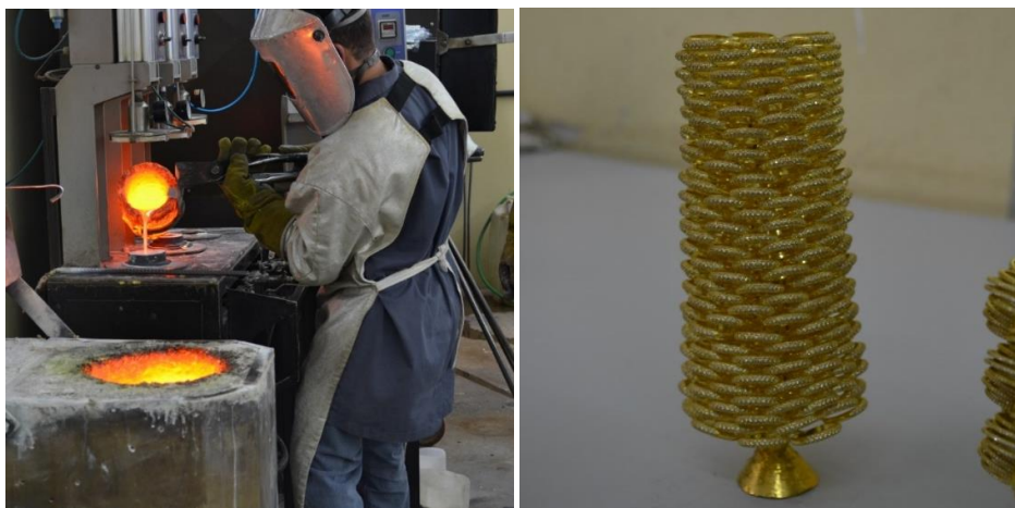
Figura 4 - Preenchimento do molde de gesso com metal líquido e árvore em metal
