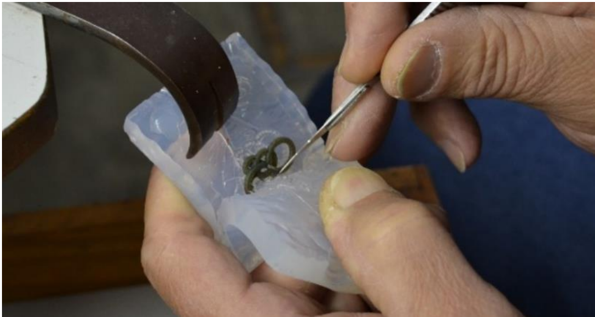
Figura 2 – Etapa 4: matriz de silicone sendo cortada.
