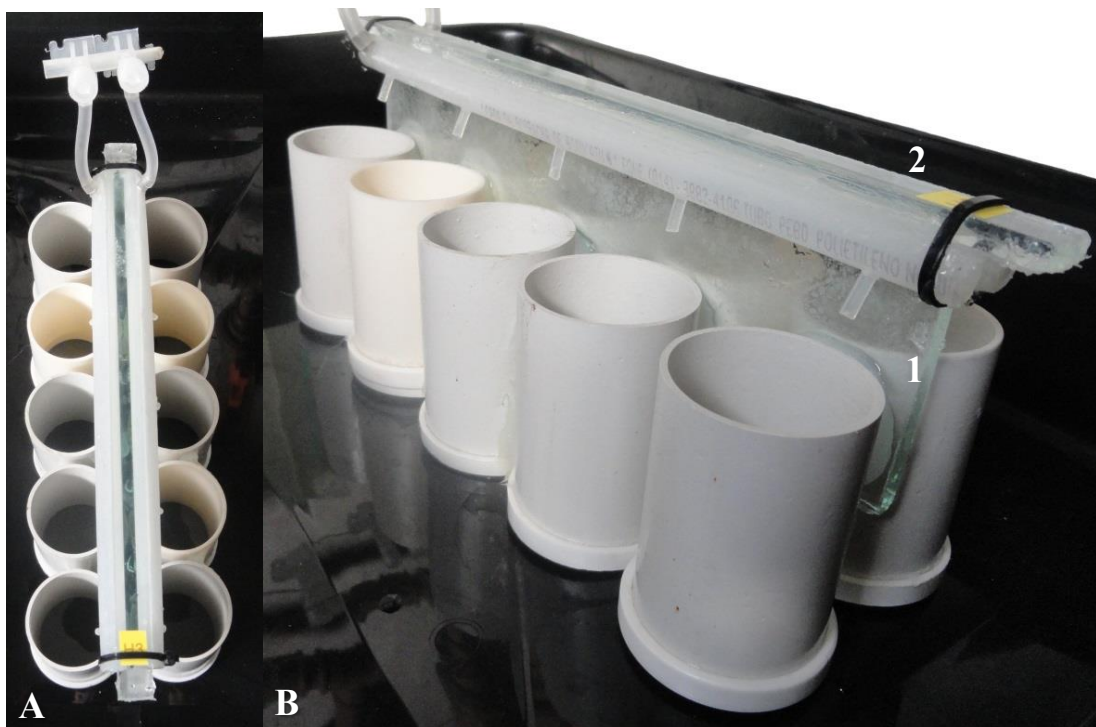
Figura 5. Conjunto de recipientes (R1) de criação individual. A, vista superior; B, vista lateral; 1= placa de vidro “1”; 2= placa de vidro “2”.
