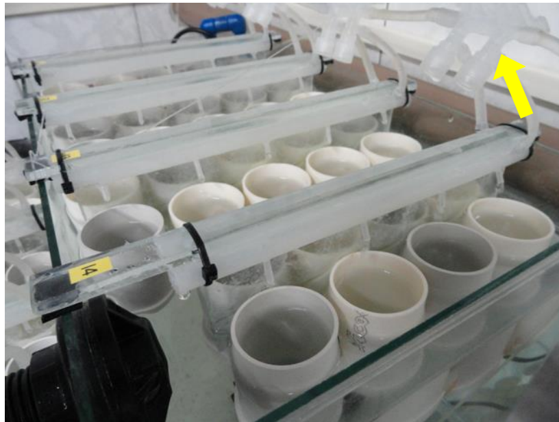
Figura 7. Detalhe do sistema de gotejamento em cada conjunto de recipiente de criação larval. Note que, sobre cada recipiente, há uma caída de água, promovendo circulação contínua e individual. Seta= divisor de ar, com função de “torneira”.
