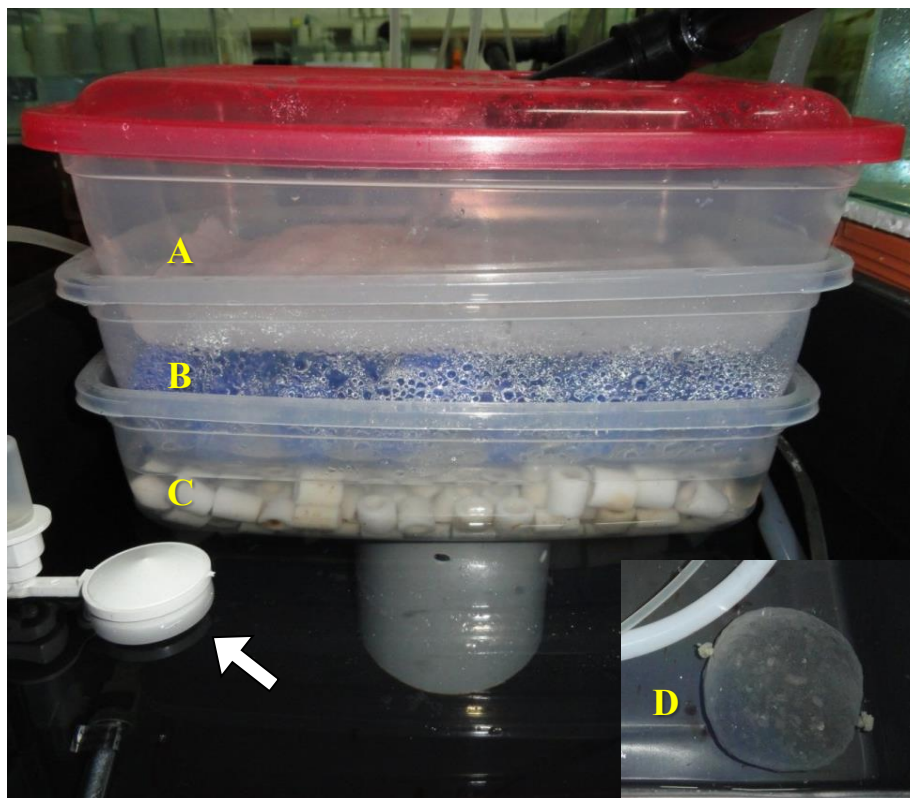
Figura 3. Detalhe do filtro no reservatório, utilizado no sistema de manutenção larval. A, lã acrílica (perlon); B, “bio balls”; C, cerâmica porosa; D, carvão ativado. Seta branca = boia plástica para reposição de água deionizada no sistema (Fig. 1, nº 2).
