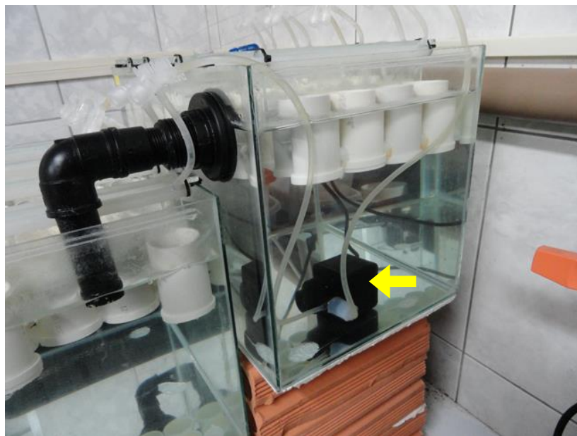
Figura 8. Detalhe da bomba de recalque (seta) que fornece circulação de água para o sistema de gotejamento.
