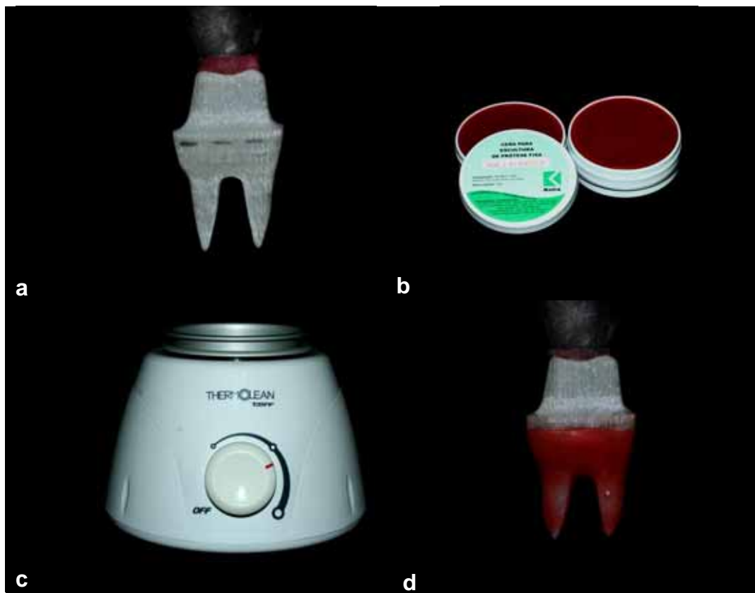
Figura 5 - a) Base antecedendo a imersão; b) Cera PW 1 plástica; c) Aparelho para aquecimento da cera; d) Base após a imersão em cera.
