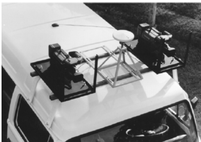
Figura 03 – Vídeo-câmaras digitais montadas como uma estéreo-câmara
