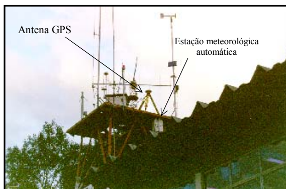
Figura 8.2. Fotografia mostrando o local em que a antena GPS foi instalada (próximo a outras antenas e sensores meteorológicos) e a estação meteorológica automática.
