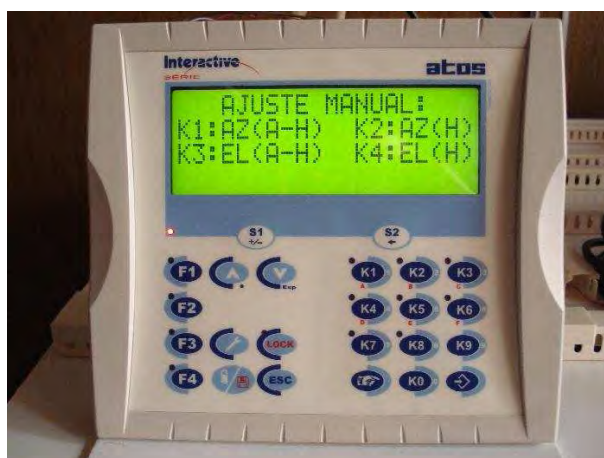
Figura 27 - Visor de instrução da I.H.M local
