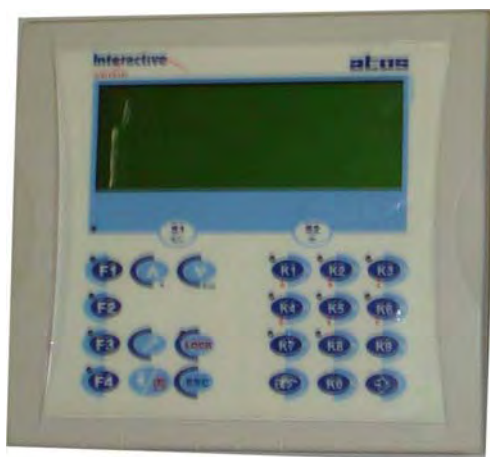
Figura 66 - I.H.M marca Atos
