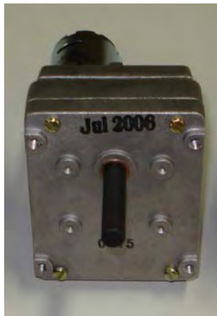
Figura 68 - Motoredutor marca Motron
