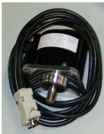
Figura 67 - Encoder marca Hohner
