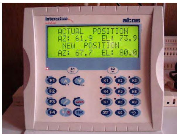
Figura 26 - Visor principal da I.H.M local
