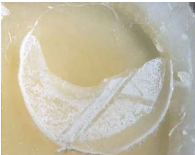
Figura 34 - Fratura mista observada em estereomicroscópio
