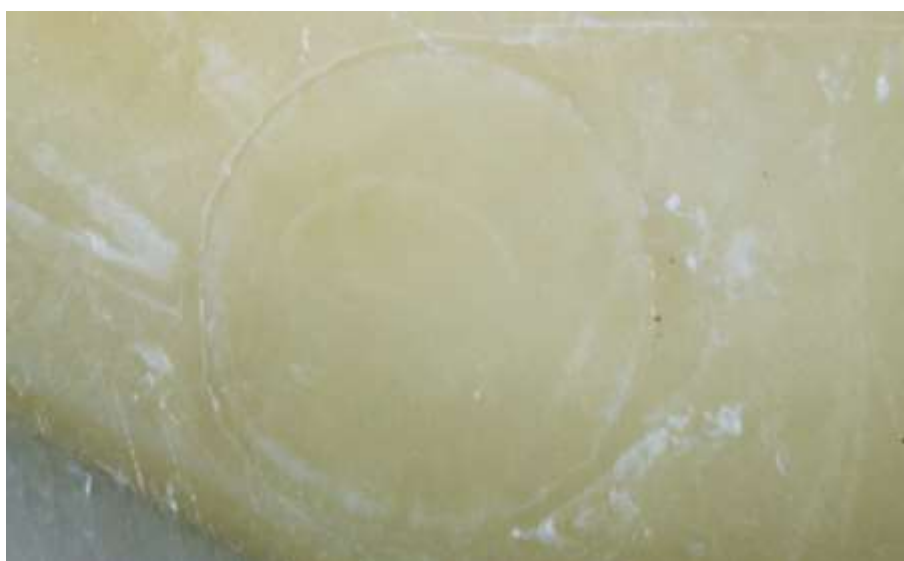
Figura 35 - Fratura adesiva observada em estereomicroscópio
