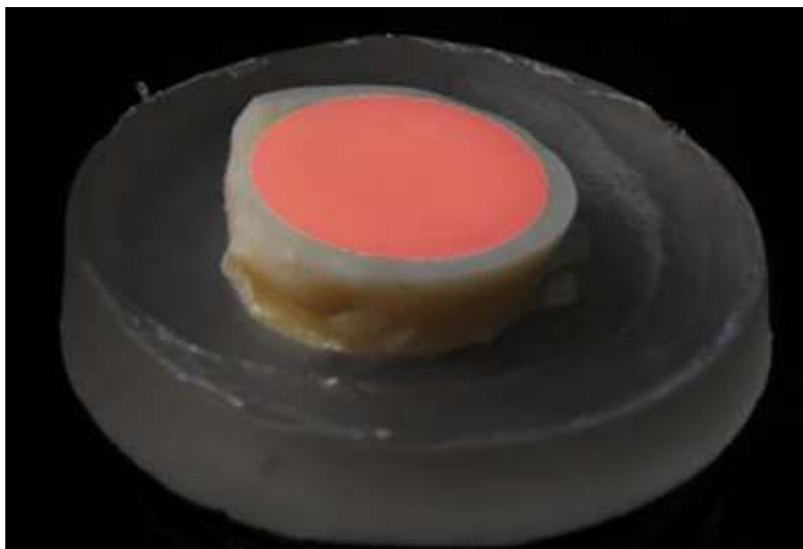
Figura 19 - Simulação de dentina irradiada
