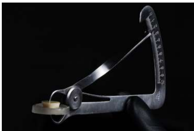
Figura 10 - Mensuração da espessura final de 2mm da dentina após sequência de polimento
