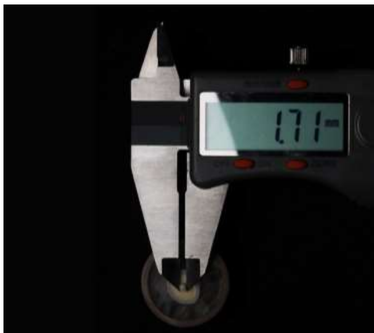
Figura 32 - Mensuração do diâmetro interno confirmado por paquímetro de precisão
