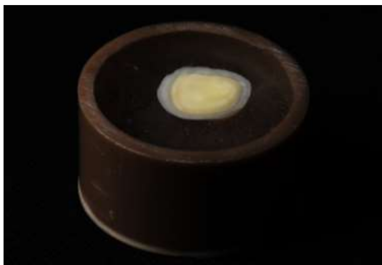
Figura 28 - Amostra com embutimento alternativo confeccionado
