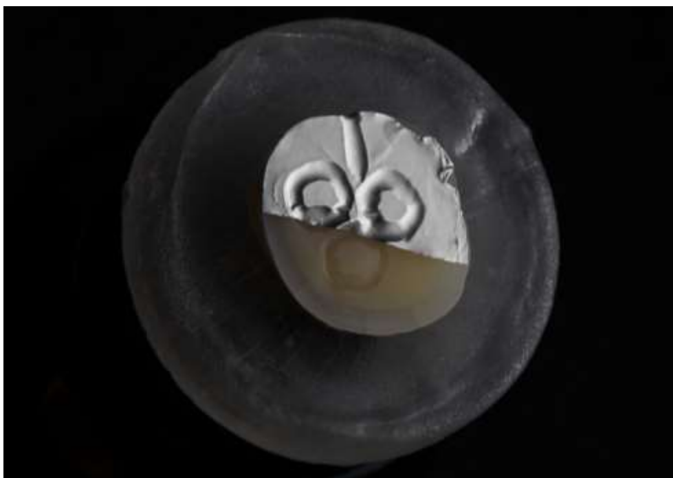
Figura 24 - Proteção das 2 áreas durante a irradiação com laser Nd:YAG
