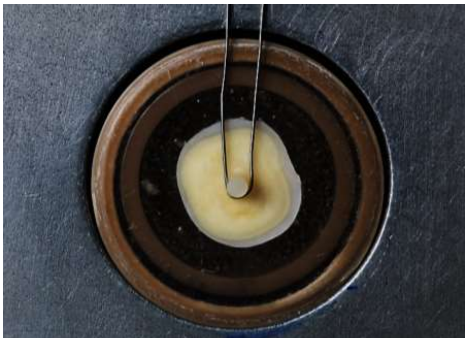
Figura 33 - Ensaio de resistência de união, simulando adaptação do fio ortodôntico ao cilindro
