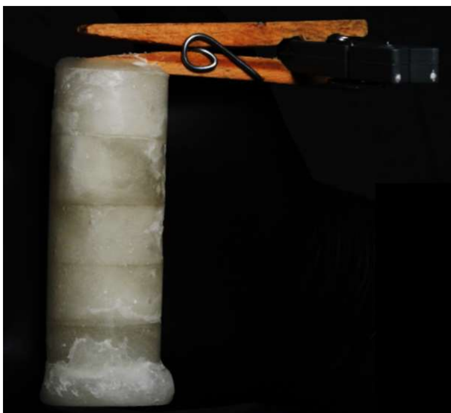
Figura 16 - Dispositivo acrílico ligado a pregadores para fixação da fibra
