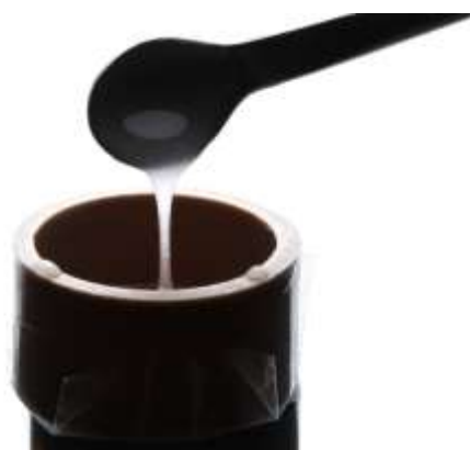
Figura 27 - Preparo do embutimento alternativo sobre tubo de policloreto de vinila
