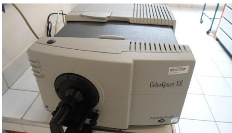
Figura 3 – Equipamento ColorQuest XE utilizado para os testes de cor.
