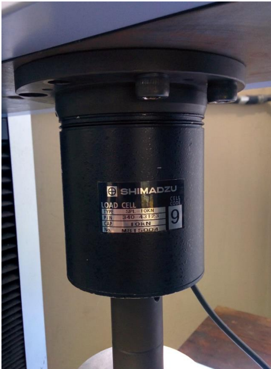
Figura 10 - Célula de carga de 10kN para equipamentos Shimadzu para ensaio de compressão.
