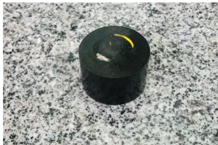
Figura 6 - Corpo de prova embutido
