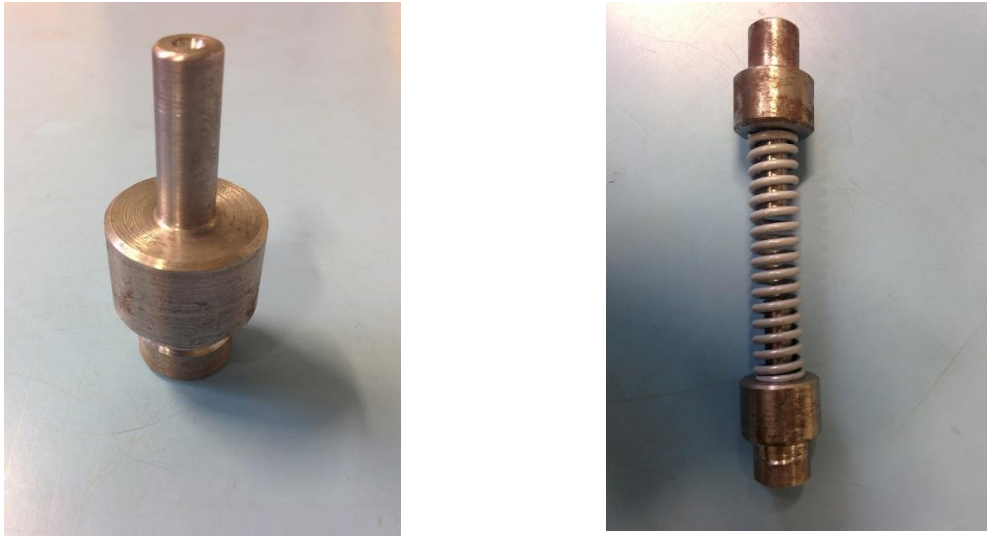
Figura 12 - (a) Suporte usinado para o ensaio de compressão, (b) montagem com os suportes
