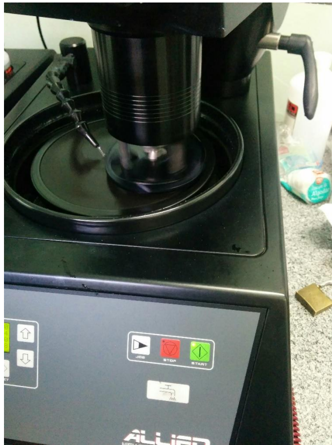
Figura 19 - (a) Politriz em funcionamento com uma das amostras
